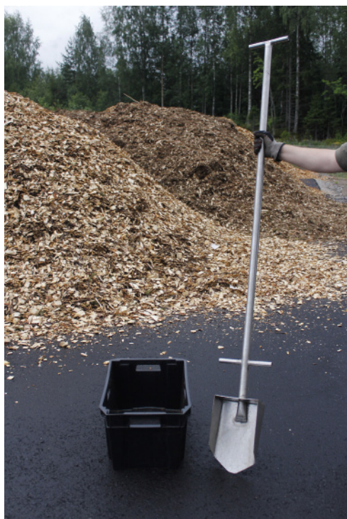
Kuva 2. Kuvassa (vasemmalla) on lapiomallinen näytteenotin polttoainekasasta tapahtuvalle näytteenotolle ja oikealla 3 litran näytteenottokauha liikkuvasta virrasta tapahtuvaan näytteenottoon . Kuva Haklog ky ja Ismo Tiihonen.
