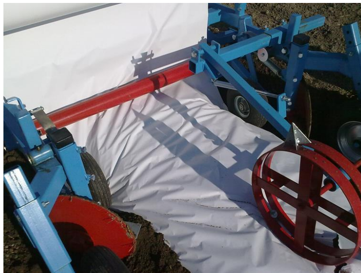
Figure 10. Mechanical laying of experimental paper mulch (H. Mikkola, A. Tamminen, UH, Viikki)
