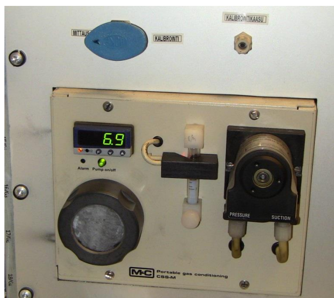
Kuva 8. Kaasujen analysointilaitteisto: a) kaasuanturit ja b) jäähdytys, kuivaus ja suodatus.
