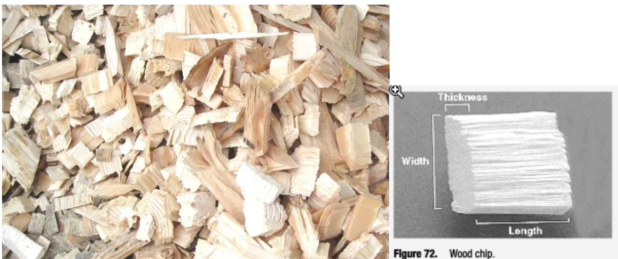
Kuva 8 Normaali tehdashake on kooltaan ja muodoltaan erityyppistä kuin kokeessa käytetty murske. Oikeanpuoleisessa kuvassa on esitetty hakedimensiot /19/.
