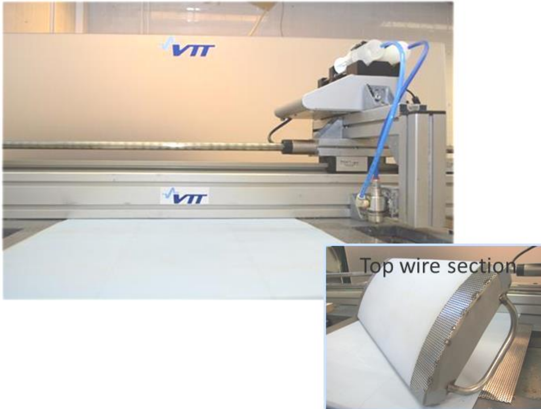
Kuva 15 Laboriolaite kuitulangan valmistukseen.
