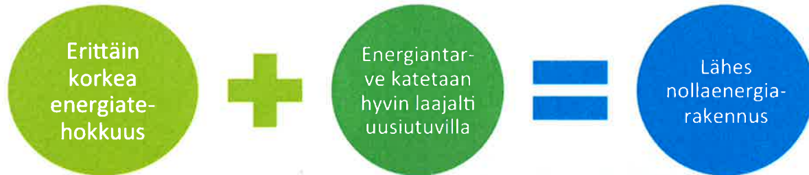
Kuva 2 Lähes nollaenergiarakennuksessa yhdistyvät korkea energiatehokkuus ja uusiutuvan energian käyttö
