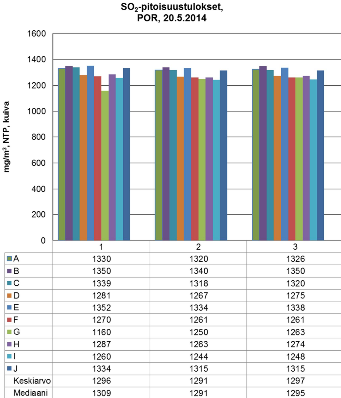
Kuva 6. SO 2 -pitoisuustulokset vertailumittauksissa 20.5.2014. Polttoaineena raskas polttoöljy POR.
