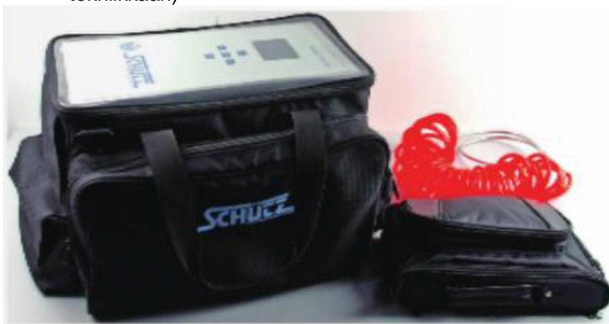
Kuva 13. Schutzin kannettava fotoakustinen mittalaite
