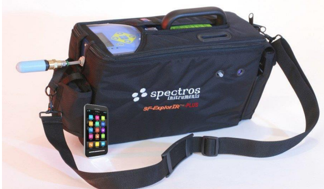
Kuva 11. Spectros-ExplorIR-mittalaite sulfuryylifluoridin analysointiin
