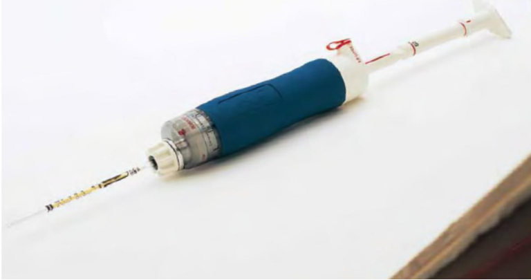
Kuva 3. Kitigawa Gas Detector Tube System-näytteenottopumppu
