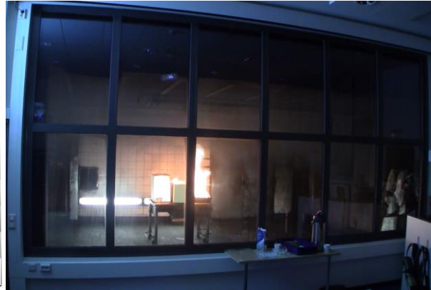
Kuva 21. Liekin muoto ja savun leviäminen sprinkleridemossa juuri ennen sprinklerin laukeamista (SD-1).
