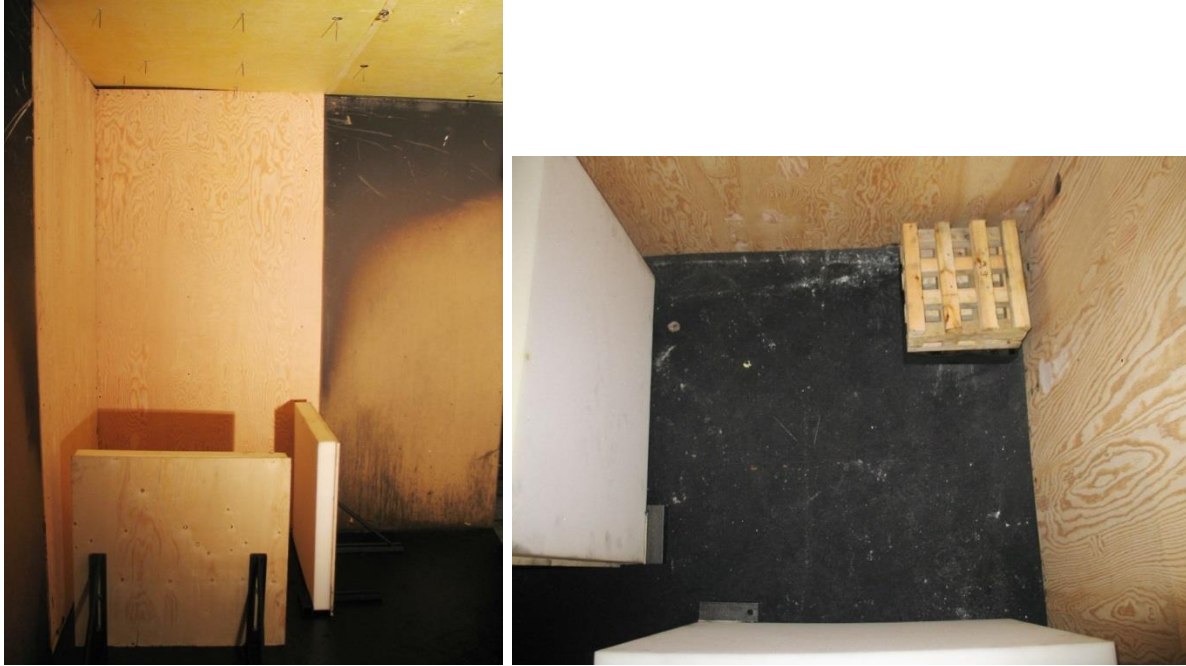
Kuva 8. Standardin UL 1626 määrittämä asuinhuonetta kuvaava palokuorma.
