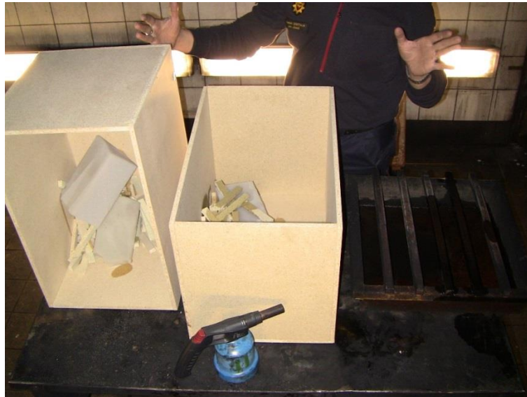
Kuva 19. Paloteatterin sprinkleridemon palokuorma. Vasemmalla piilopaloa simuloiva laatikko, keskellä avopaloa simuloiva laatikko, ja oikealla nesteallas.
