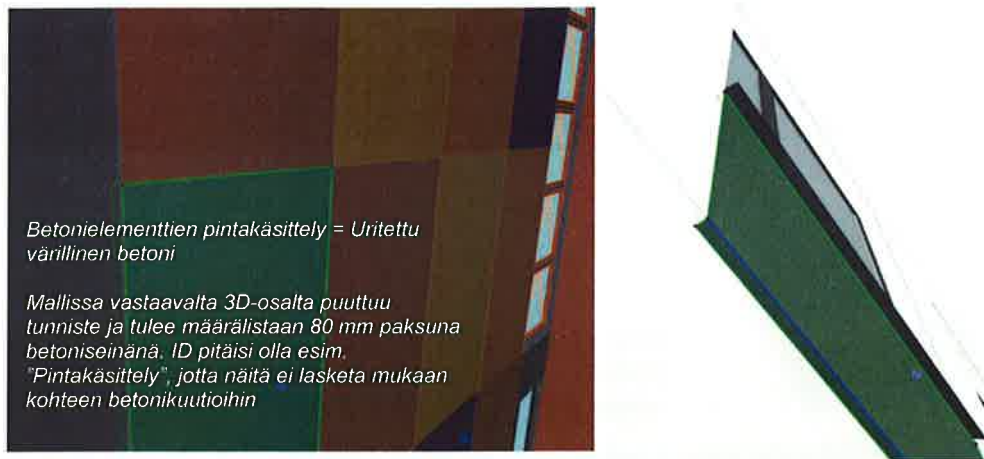
Kuva 8. A) Pintakäsittelyltä (uritettu betoni) puuttuu toimiva tunniste B) Pintakäsittelyn tunniste on kunnossa ("Rappaustehoste"), mutta määrä pitää vähentää pääpintakäsittelystä.
