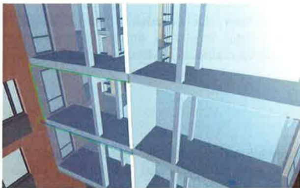
Kuva 5. Parvekekaiteiksi nimettyjä lasituksia arkkitehtimallissa.
