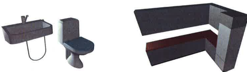
Kuva 7. Esimerkkejä arkkitehtimallin tilavarusteista: märkätilakalusteita sekä keittiökalusteiden tilavarauusobjekti.
