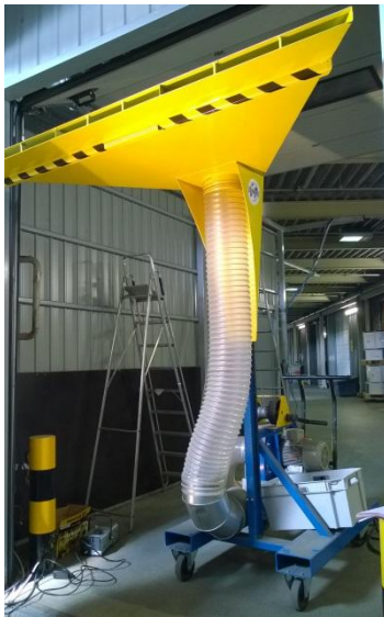
Kuva 4. Konttien tuulettamiseen suunniteltu ja testeissä käytetty keskipakopuhallin.
