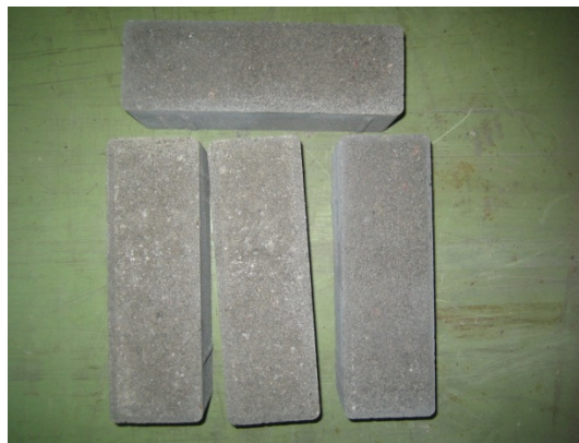
Kuva 1. Tutkimuksiin käytettyjä Ruduksen betonikiviä (Luostarikivi h80 x 68 x 208 mm 3 ).
