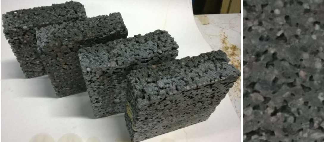
Kuva 50. Menetelmän A (jäädytys-sulatus vedessä) koekappaleita (PC5) 56 jäädytys-sulatuskierroksen jälkeen. Betonin suojuhuokostuksen määrä oli 2,2 % betonissa (>10 % sementtipastassa).
