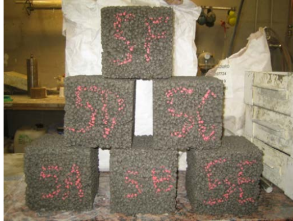
Kuva 53. Puristuslujuustestausta varten valmistettuja koekuutioita (150 mm). [Holt 2016]
