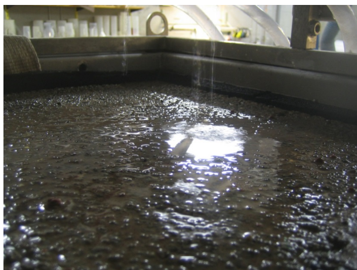
Kuva 76. Valumaa läpäisevän betonin PC1 pinnalla mitoitussadetta selvästi suuremmalla sadetuksella (4-kertaisella).
