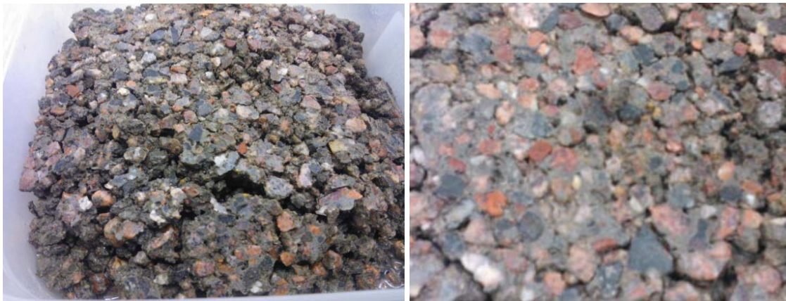
Kuva 49. Menetelmän A (jäädytys-sulatus vedessä) koekappaleiden vaurioituminen. Betonin suojarahukosten määrä oli erittäin pieni, vain 0,2 % betonissa (1,3 % sementtipastassa).
