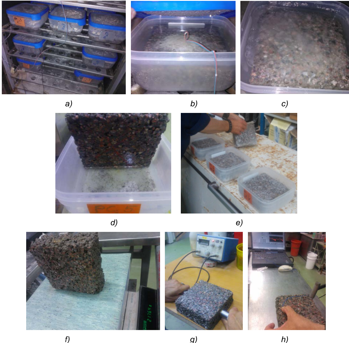
Kuva 32. Jäädytys-sulatuskokeiden (ks. taulukko 22) eri vaiheita: a) Koekappaleita jäädytys-sulatuskaapissa muovivastioissa; b) Lämpötilan mittaus koekappaleen keskeltä (menettelyssä A); c) Koekappale sulamisvaiheessa, vesi vielä osin jäässä (menettely A); d) pakkas-suolakokeen koekappale ja astiassa pohjalla NaCl-liuosta ja hieman rapautunutta ainesta (menettely B); e) Koekappaleita muoviin käärittyinä (menettely C); f) Koekappaleen punnitus; g) Ultraäänmittaus (UPVT); h) Ominaisfrekvenssin (FF) mittaus.
