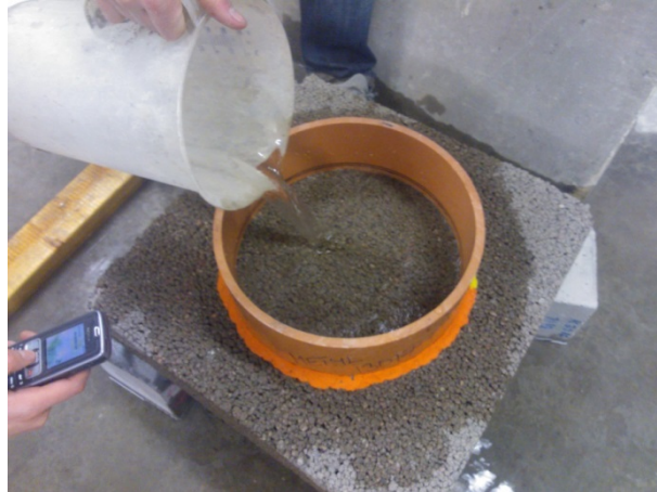
Kuva 14. ASTM C1701/C1701M-09 mukainen vedenläpäisevyyskoe.
