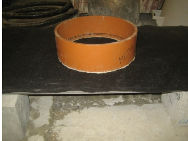
Kuva 51. Geotekstiilin vedenläpäisevyyden mittauksessa käytetty järjestely. [ASTM C1701/C1701M: 2009]
