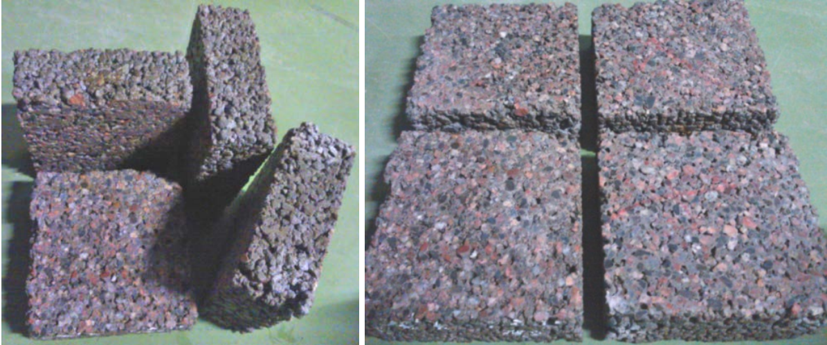
Kuva 48. Menetelmän C (jäädytys-sulatus muovissa) koekappaleet (PC3) kokeen jälkeen eli 56 kierroksen jälkeen. Sisäinen vaurioitumisaste (RDM) keskimäärin vain 0,91 (keskihajonta 0,12) huolimatta siitä, että betonin PC3 kestävyys ei ollut kaikkiaan hyvä.
