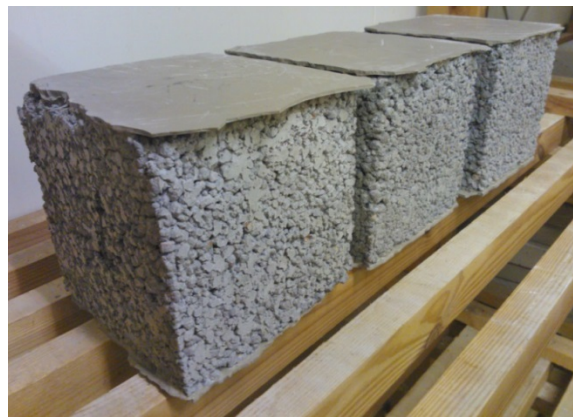
Kuva 25. Puristuslujuusmääritykset tehtiin 150 mm kuutioilla, jotka rikitettiin. Kuvassa kuutiot puristuslujuustestauksen jälkeen.
