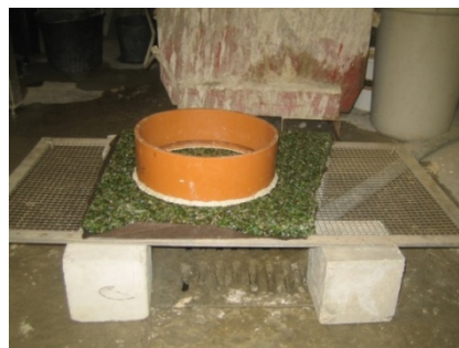
Kuva 56. FilterPave® laatan vedenläpäisevyyden testaus.
