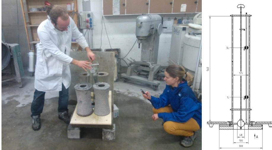
Kuva 13. Vasemmalla: EN 12697-40 mukainen vedenläpäisevyyden mittausjärjestely. Oikealla: kuva standardin mukaisesta mittauslaitteesta (näkyv vasemmassa kuvassa keskellä).
