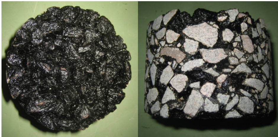
Kuva 9. Avoin asfaltti, pohjamassa Lempore 16B. Esimerkkiorapala ylhäältä ja sivulta.
