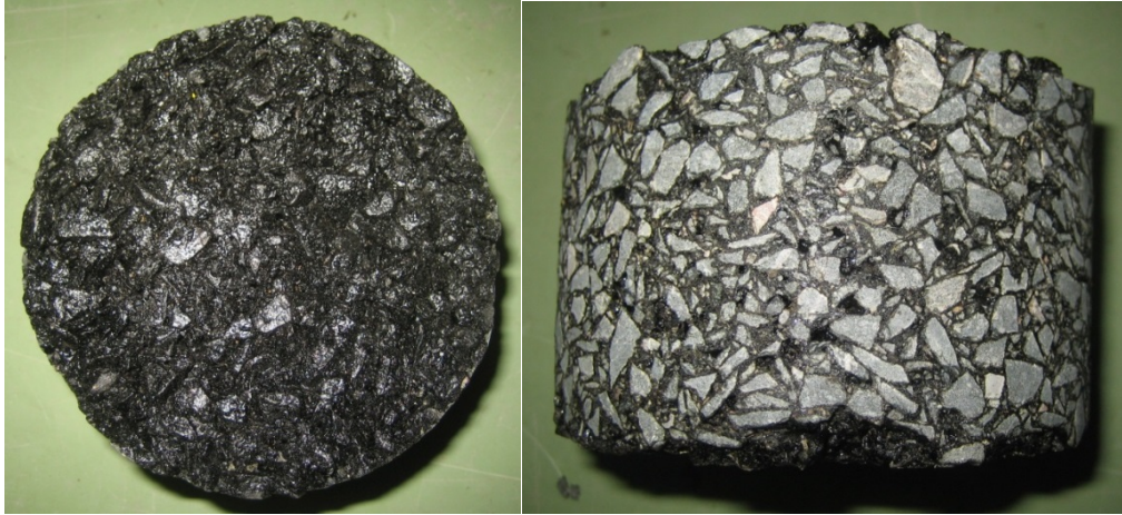
Kuva 8. Avoin asfaltti, tiivis pintamassa Lempore 8T. Esimerkkiorapala ylhäältä ja sivulta.
