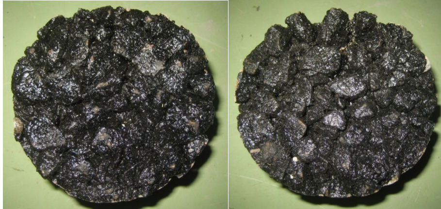
Kuva 12. Avoin asfaltti, Lempore 16B. Vasen: Vasen: Jäädytys-sulatuskokeen näyte halkaisuvetolujuuskokeen jälkeen. Oikea: Referenssinäyte halkaisuvetolujuuskokeen jälkeen.
