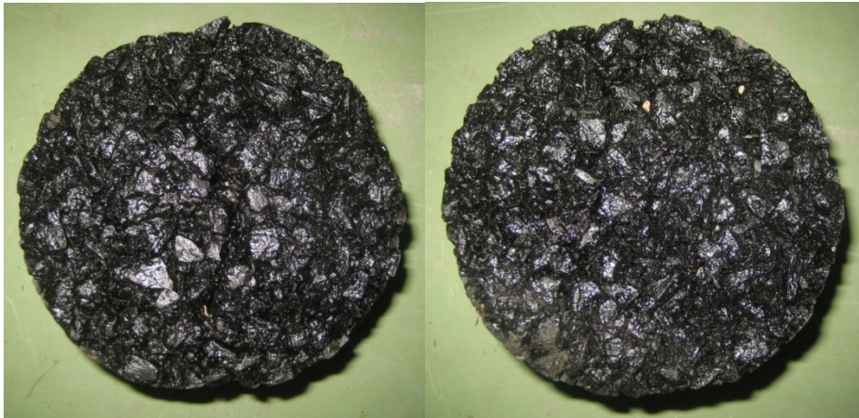
Kuva 10. Avoin asfaltti, Lempore 8T. Vasen: Jäädytys-sulatuskokeen näyte halkaisuvetolujuuskokeen jälkeen. Oikea: Referenssinäyte halkaisuvetolujuuskokeen jälkeen.
