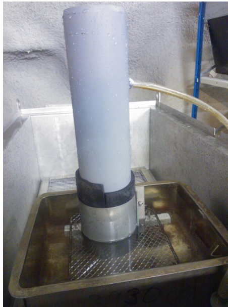
Kuva 16. Kuva standardia EN 12697-19:2012 mukailleessa kokeessa käytetystä laitteesta. Porapala ja vesiputki on yhdistetty mansetilla solukumia tiivisteenä käyttäen. Vesi valuu pienemmästä altaasta uloimpaan altaaseen, jonka pohjassa on ulostulo ja talteenotto vedelle.
