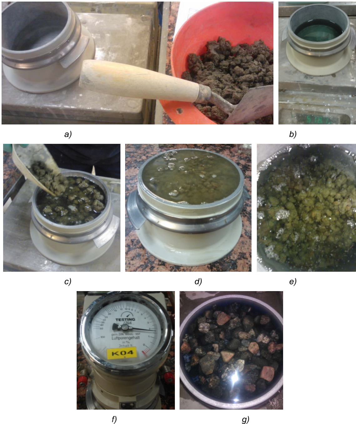
Kuva 27. LB-massan ilmamäärämittauskokeilun vaiheet: a) Tyhjä 1 litran ilmamäärämittari vaa'an päällä ja mittausta varten otettu LB-massanäyte (tiivistämätön); b) Ilmamäärämittariin lisätään vesi-glyseroliseosta; c) Ilmamäärämittariin lisätään vähittäin LB-massaa; d) ja e) Ilmamäärämittari täytetään kokonaan LB-massalla ja vesi-glyseroliseoksella, joiden molempien määrät punnitaan (kaikki lisäykset vaa'an päällä). Suuret ilmahuokokset nousevat nesteen pinnalle eivätkä tule mukaan mittaukseen; f) Ilmamäärä mitataan normaalisti; g) Pelkkää kiviainesta ja vesi-glyseroliseosta ilmamäärämittarissa 'kalibroitimittausta' varten.
