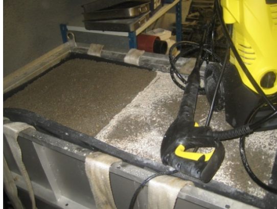
Kuva 62. Liattu läpäisevä betoni (PC0). Oikean puoleinen laatta on imuroitu ja vasemman puoleinen laatta sekä imuroitu että painepesty.
