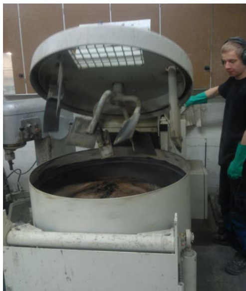
Kuva 21. LB-massojen valmistuksessa käytetty 170 litran sekoitin.
