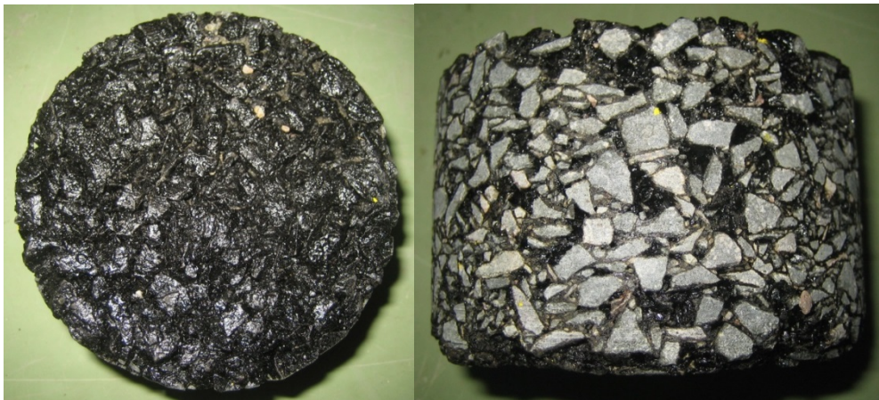
Kuva 7. Avoin asfaltti, avoin pintamassa Lempore 8P. Esimerkkiporapala ylhäältä ja sivulta.
