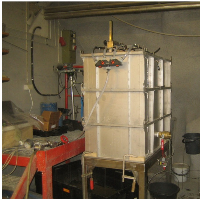
Kuva 57. Rig-laitteisto kolmella kasetilla ja niiden päällä sadetusyksikkö.
