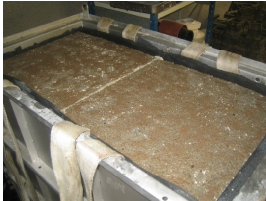
Kuva 61. Hiekka-kaoliiniseoksella (50/50 paino-%) liattu PC1-betonilaatta.
