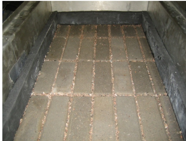
Kuva 59. Betonikivipinta Rig-kasettiin rakennettuna. Betonikivien väleissä vettä läpäisevää kiviainesta.
