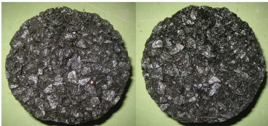
Kuva 11. Avoin asfaltti, Lempore 8P. Vasen: Jäädytys-sulatuskokeen näyte halkaisuvetolujuuskokeen jälkeen. Oikea: Referenssinäyte halkaisuvetolujuuskokeen jälkeen.
