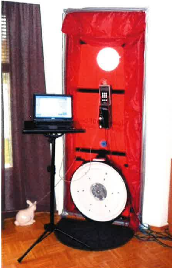
Kuva 15. Blower Door –mittauslaitteisto ilmatiiviyden määrittämiseen suhteellisen pienissä kohteissa.
