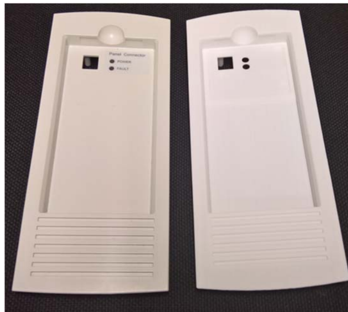
Kuva 24. Ruiskupuristettu elektroniikkakotelo vasemmalla ja lasersintrattu oikealla.
