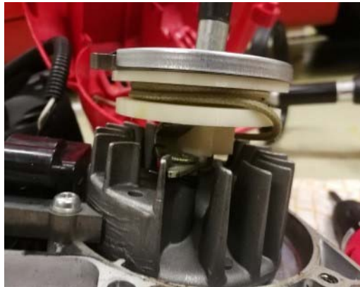
Kuva 21. 3D-tulostettu ratas asennettuna.
