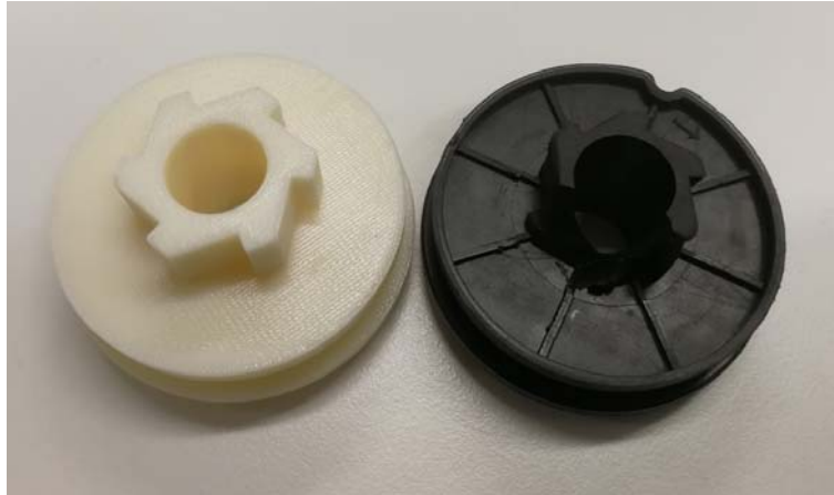
Kuva 20. Alkuperäinen ratas oikealla ja 3D-tulostettu ratas vasemmalla.
