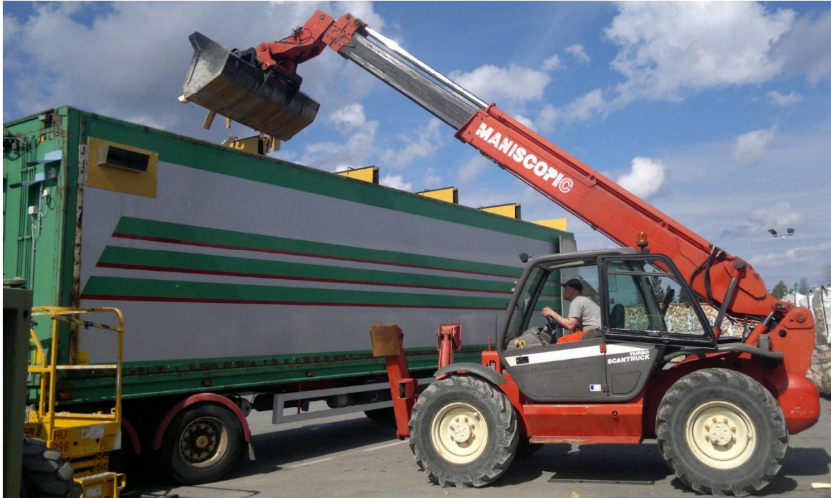
Kuva 7. Rekan perävaunuun rakennettu pilkekuivuri. Täyttö tapahtuu avattavan katon kautta. Purkua varten on asennettu pohjapurkain. (Lähde: E. Lehtola Ky.)
