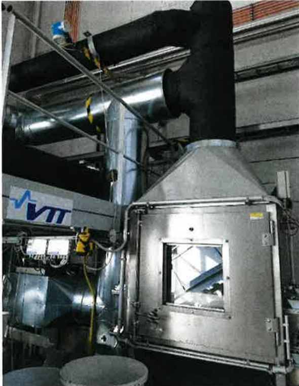
Kuva 14. VTT:n biomassakuivuri. Auringolla lämmitetty ilma tulee mustaa ilmanavaa pitkin (vasen). Oikealla sisäkuva kuivauskaapista, jossa on 0,3 m 3 kuivausastia. Astian reunoja korottamalla kapasiteettia voidaan laajentaa aina yhteen kuutiometriin asti.
