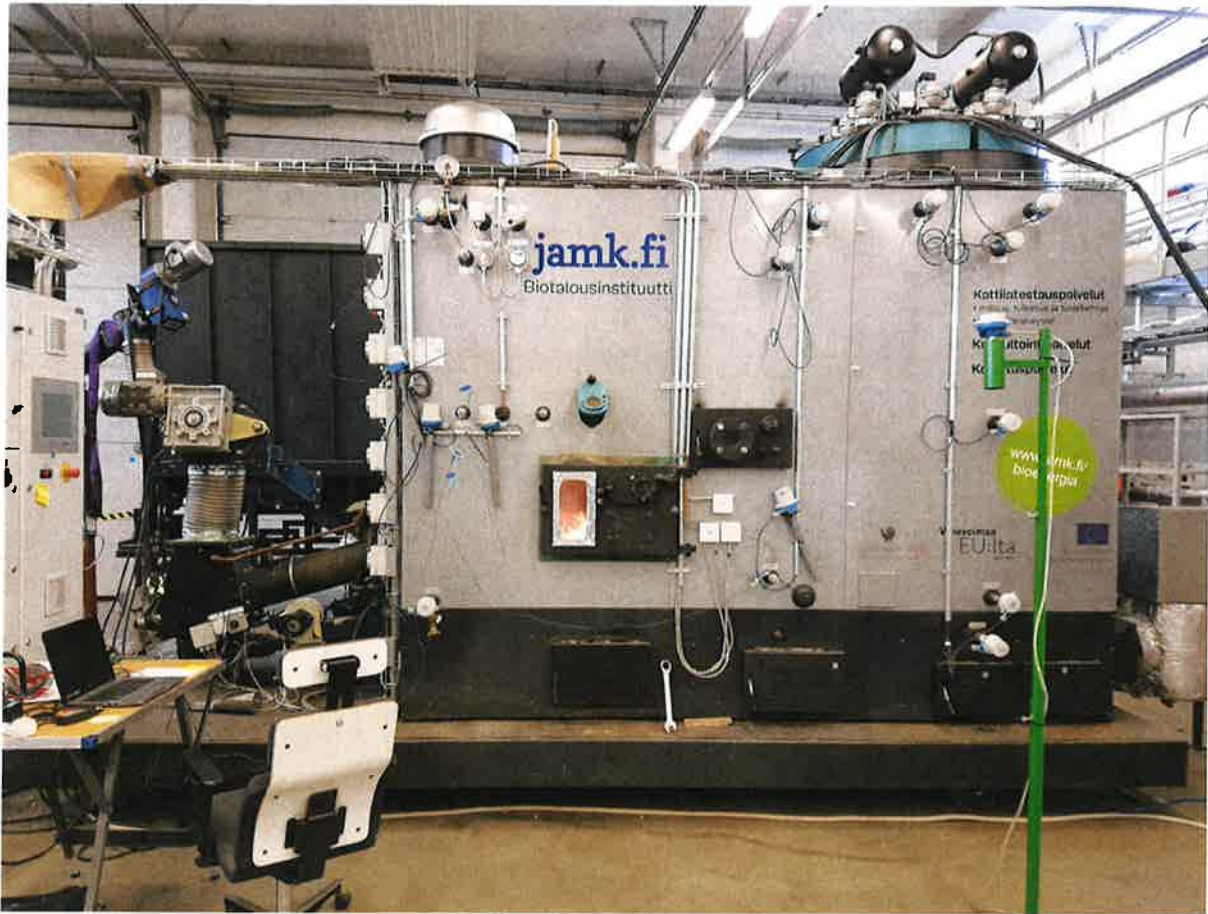
Kuva 1. Biotalousinstituutin kattilatestauslaboratorion 500 kW haketestauskattila.
