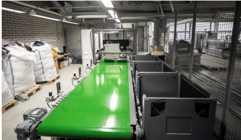
Kuva 5 Lahden ammattikorkeakoulun kehittämä automatisoitu lajittelulinjasto, REISKA ® tex. Kuva Oona Rouhiainen, LAMK, 2018
