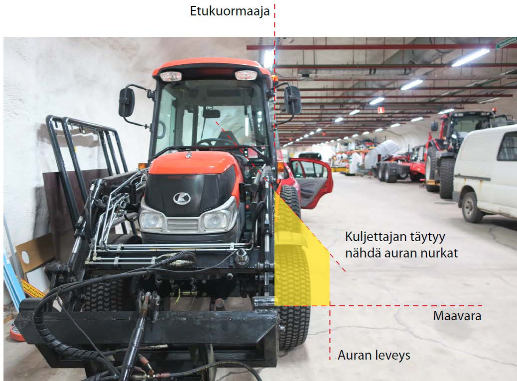
Kuva 6. Helsingin liikuntatoimen Kubota-traktorin etupuolella oleva mahdollinen tila kellukkeelle.
