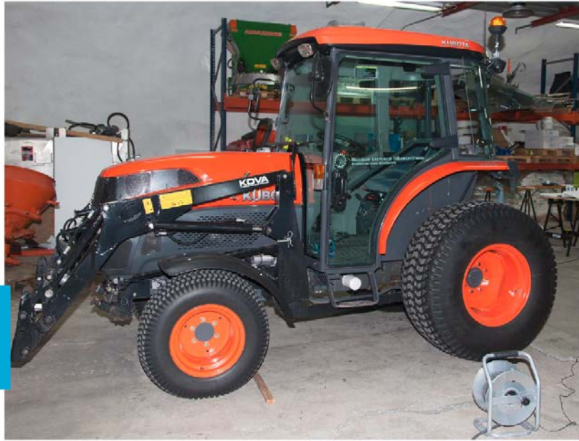
Kuva 4. Etukuormaajan ja auran väliin liitettävän rakenteen todettiin heikentävän ohjattavuutta merkittävästi.
