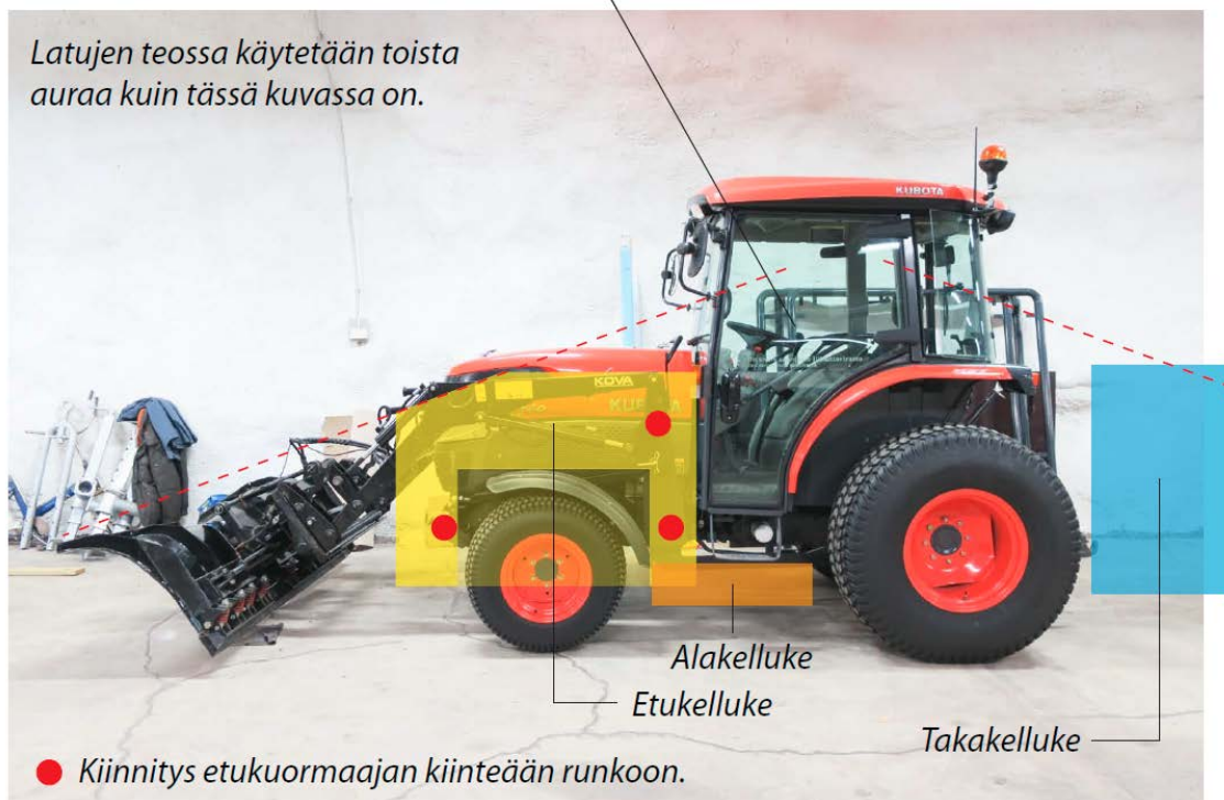
Kuva 5. Helsingin liikuntatoimen Kubota-traktorin mahdollinen kellukkeiden sijoittelu. Etukellukkeet on mahdollista kiinnittää etukuormaajan kiinnityksiin.
