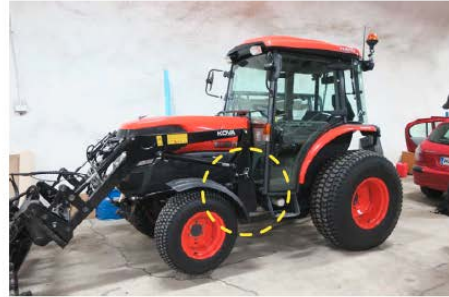
Kuva 9. Helsingin liikuntatoimen Kubota-traktorin etukuormaajan rakenteita, joita voidaan mahdollisesti käyttää kellukkeiden kiinnityksessä.
