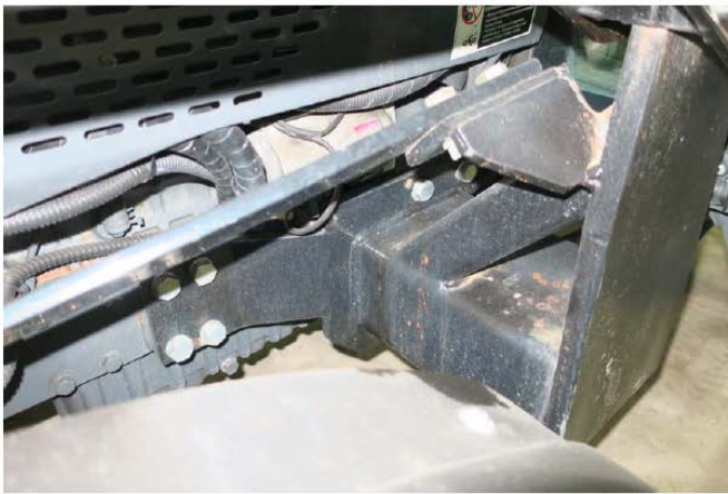
Kuva 9. Helsingin liikuntatoimen Kubota-traktorin etukuormaajan rakenteita, joita voidaan mahdollisesti käyttää kellukkeiden kiinnityksessä.
