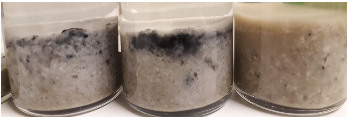
Kuva 2. Hapellisissa olosuhteissa aloitettu bentoniitin pitkäaikaisäilytyskoe 2 kk ravinnelisäyksen jälkeen. Oikealla abioottinen kontrollibentoniittipullo, jonka bentoniitti ja kivimurska on kuumakäsitelty ja vesi steriilisuodatettu.
