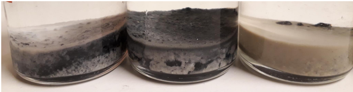
Kuva 1. Hapettomissa olosuhteissa aloitettu pitkäaikaisbentoniittikoe 2 kk ravinnelisäyksen jälkeen. Oikealla abioottinen kontrollibentoniittipullo, jonka bentoniitti ja kivimurska on kuumakäsitelty ja vesi steriilisuodatettu, ja jossa ei ole havaittu tummumista missään vaiheessa koetta.
