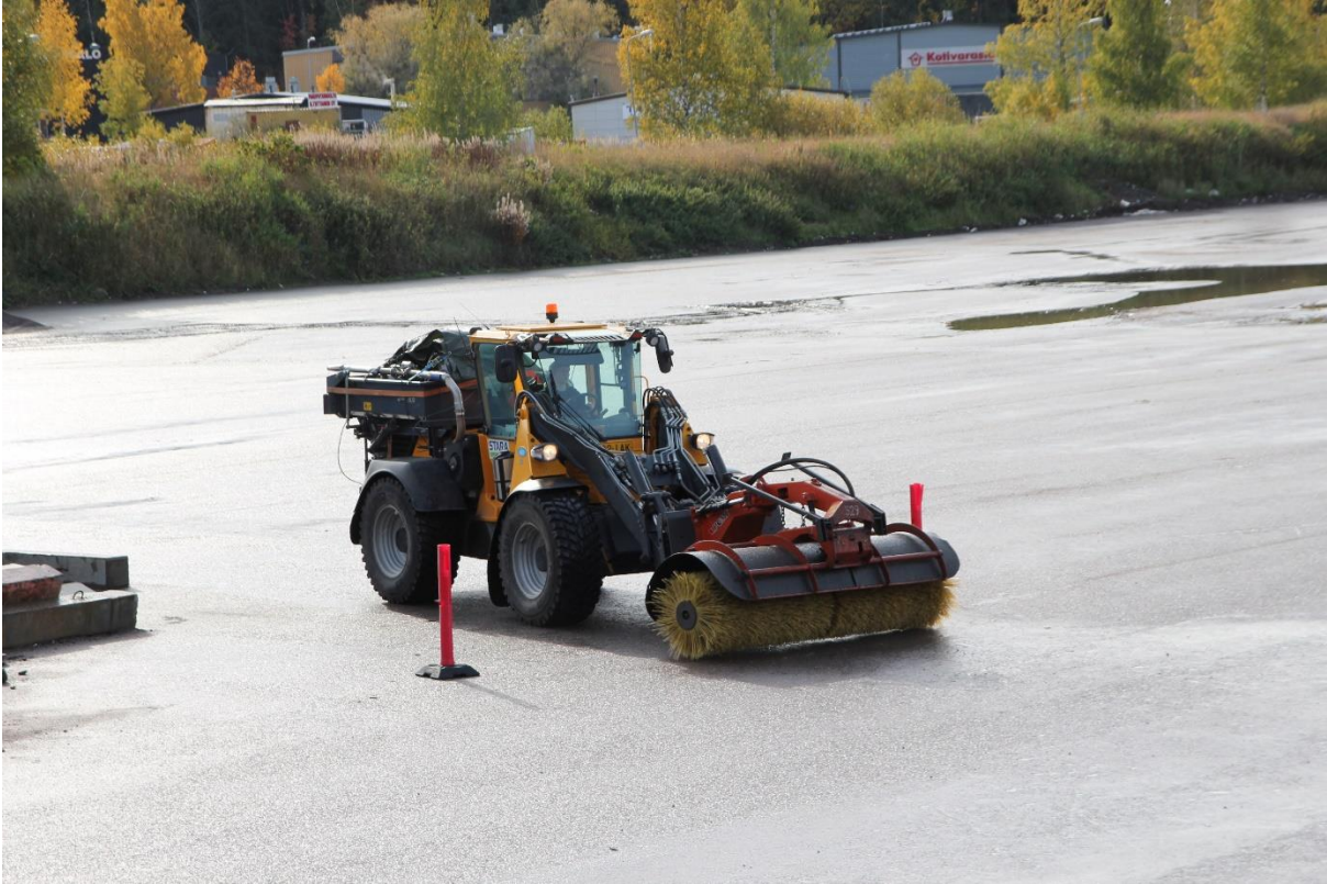
Kuva 6.4. Wille 865 monitoimipyöräkuormaaja testisyklillä.
