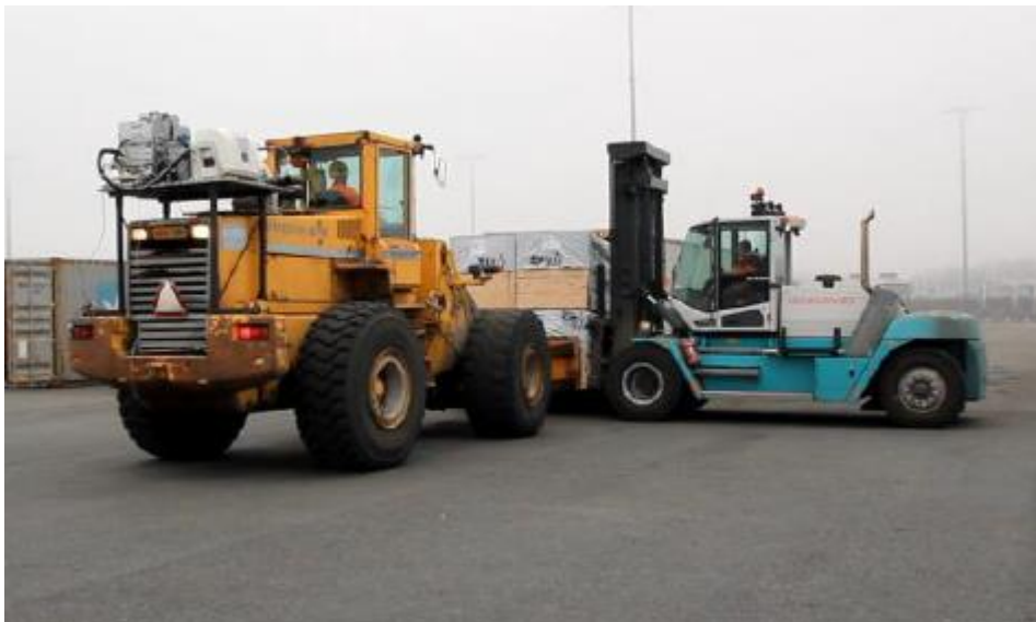
Kuva 6.9. PEMS-laitteistolla varustettu kauhakuormaaja (keltainen kone) siirtämässä puunippua.
