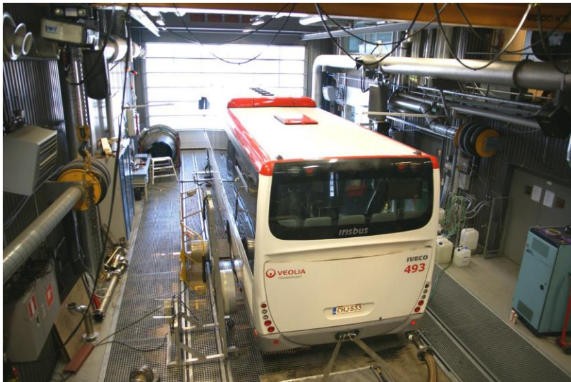
Kuva 5.1. Yleisnäkymä ajoneuvolaboratoriosta. Ylhäällä oikealla näkyy CVS-laitteiston laimennustunneli. Laboratorion lämpötila vakioidaan mahdollisimman tarkan toistettavuuden saavuttamiseksi.
