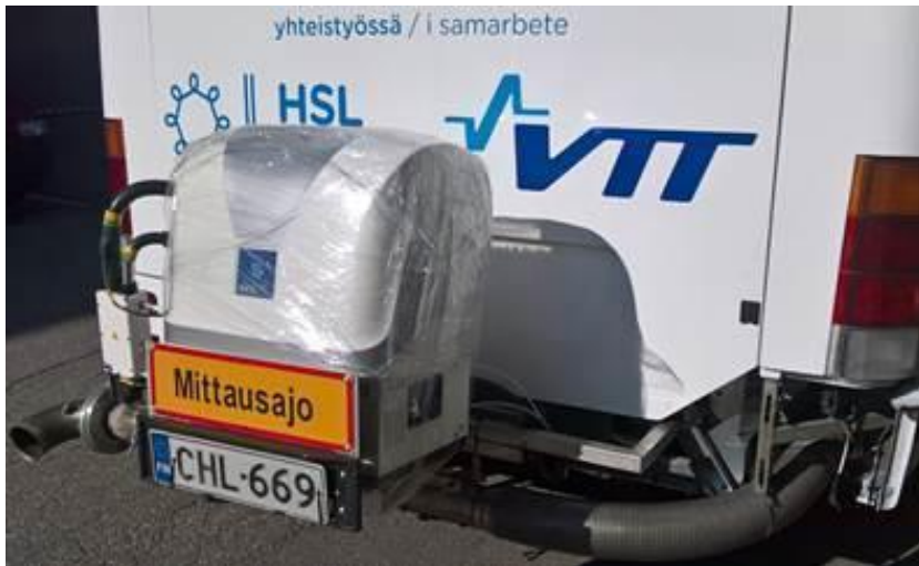
Kuva 5.2. PEMS-laitteiston näytteenkeräysosa asennettuna bussin taakse.
