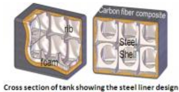
Kuva 18: UTRC:n kehittämä suorakaiteen muotoisen CNG säiliö. [35]
