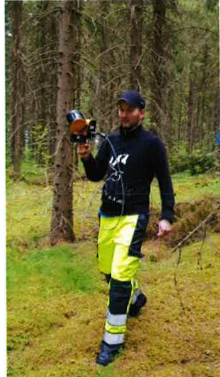
Kuva 6. Vasen: ZEB Horizon keilaimen kanssa kuljettu maastoreitti Keuruulla. Oikea: Keilaus maastossa.
