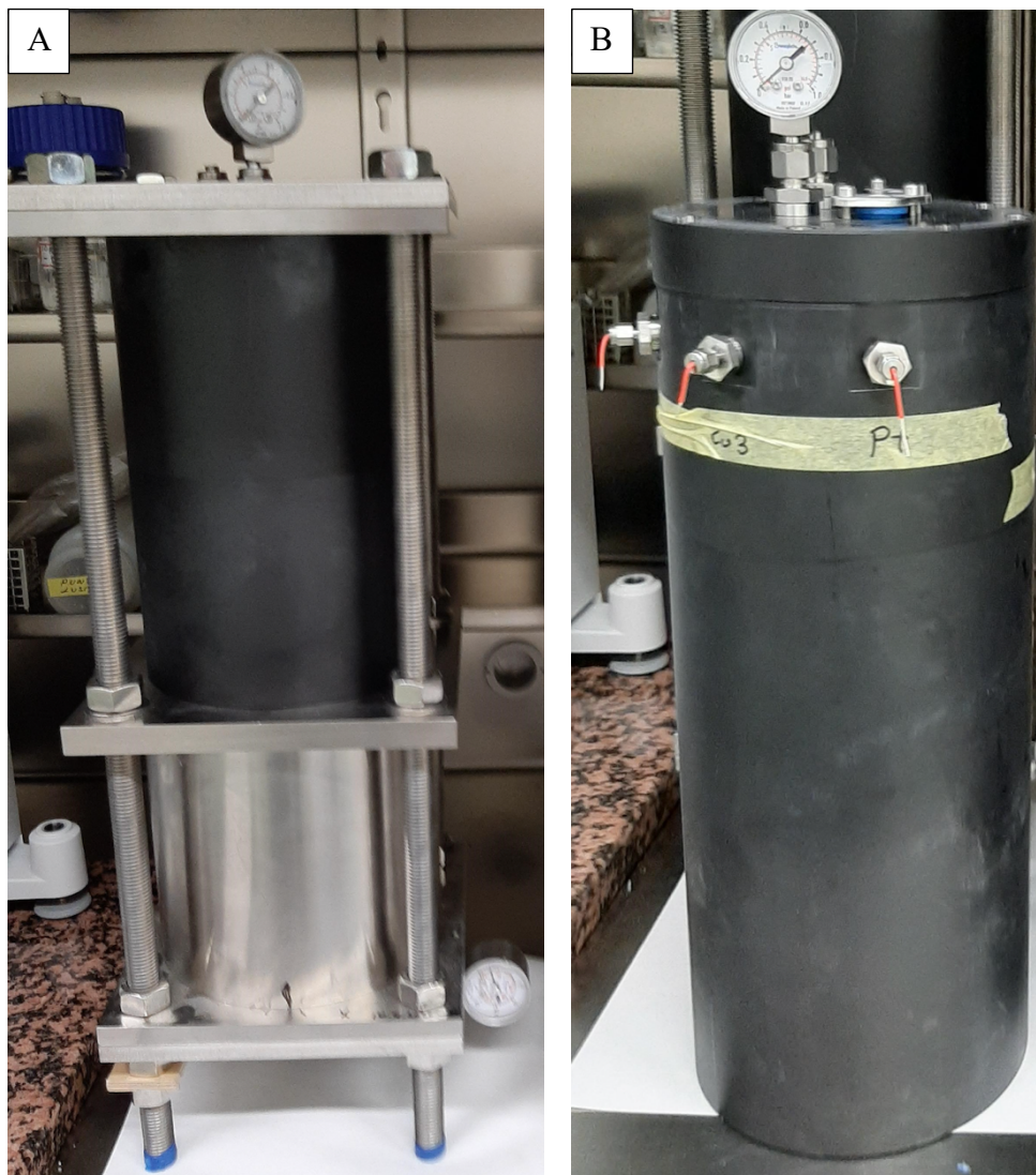
Kuva 2. POM-reaktorit. A) Kompaktoidun ( 1,4 \text{ g/cm}^3 ) bentoniitin POM-reaktori B) Slurry-POM reaktori, jossa yläreunassa näkyvät korroosioantureiden läpiviennit ja päällä painemittari sekä kumiyhde (sininen) kaasujen vaihtoa ja ravinnelisäyksiä varten.
