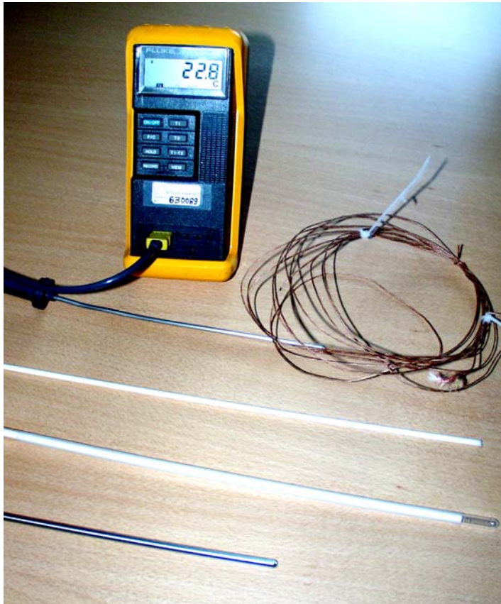
Kuva 5.1. Ylhäällä on digitaalilämpömittari, johon on kytketty K-tyypin termoelementti, oikealla on K-tyypin termoelementtilanka, näiden alla on S-tyypin termoelementti suojaputkessaan, ja sen alla on kulta-platina-termoelementti. Alimpana on kulta-platinatermoelementin referenssiiliitos.
