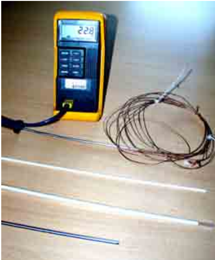
Kuva 5.1. Ylhäällä on digitaalilämpömittari, johon on kytketty K-tyypin termoelementti, oikealla on K-tyypin termoelementtilanka, näiden alla on S-tyypin termoelementti suojaputkessaan, ja sen alla on kulta-platina-termoelementti. Alimpana on kulta-platinatermoelementin referenssi-liitos.
