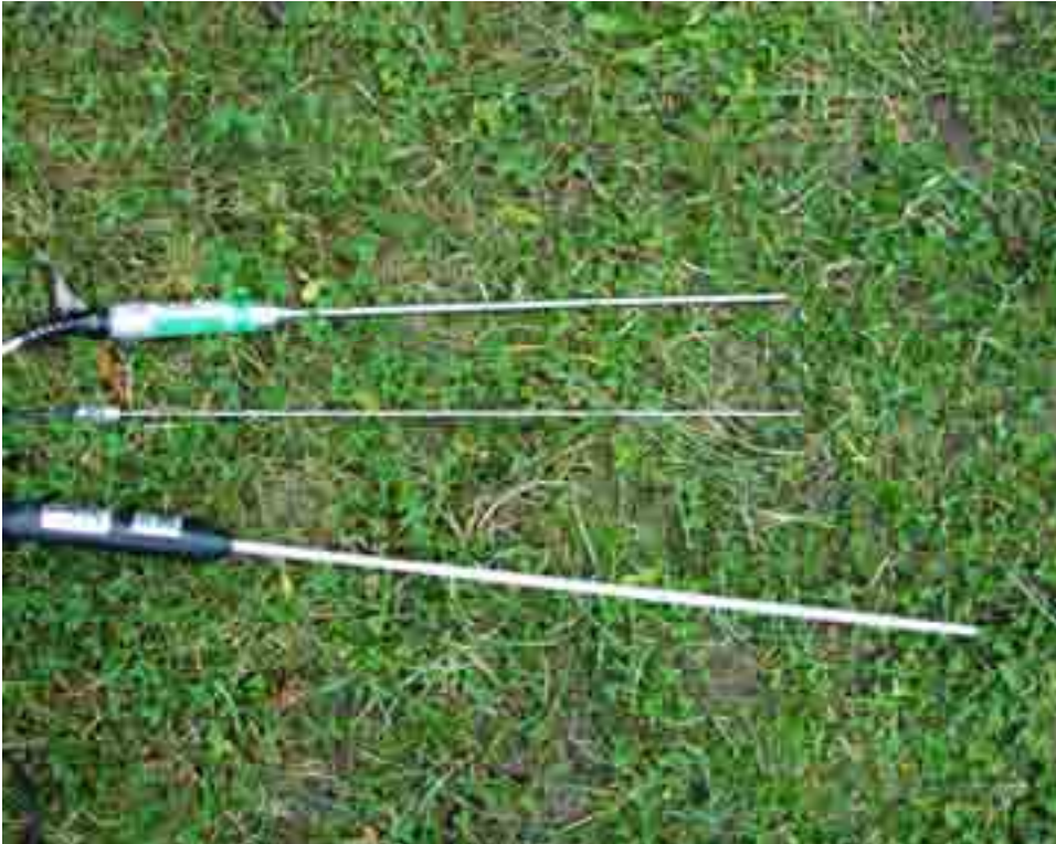
Kuva 6.1 Pt100-antureita, edessä kvartsikuorinen anturi ja sen takana kaksi metallikuorista anturia
