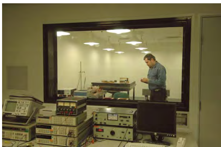
Kuva 7.1. Kalibroinnin valmistelua MIKESin akustiikkalaboratoriossa. Kuva on otettu valvontahuoneesta käsin. Itse mittaushuone on ääni- ja tärinänielessä muusta rakennuksesta eristetty.
