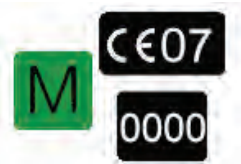
Kuva A6. Vaa'an vaatimustenmukaisuuden ilmaiseva merkkijohdistelmä. Tässä esimerkissä vaa'an seuraava varmennus on tehtävä viimeistään vuoden 2010 lopussa
