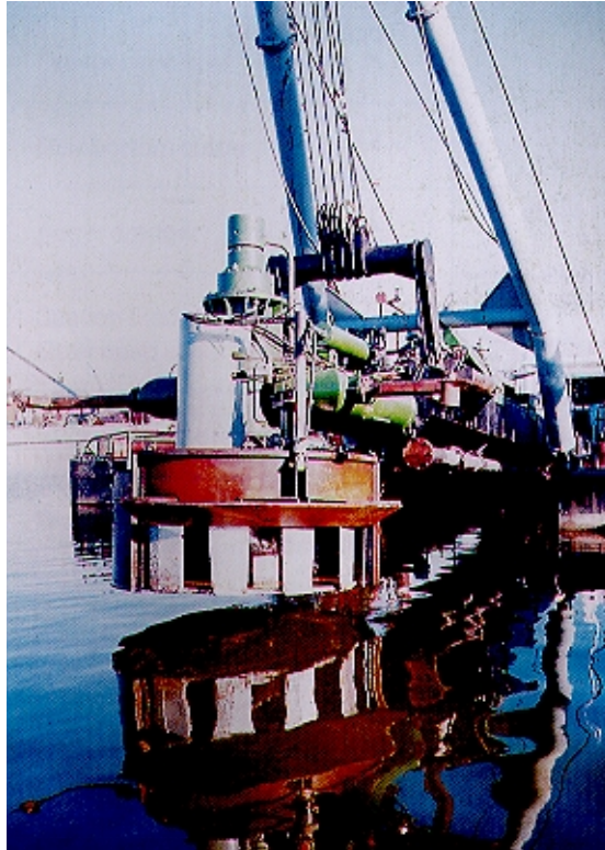
Kuva 23. Levyleikkuriruoppaaja (disc bottom cutter) (Rokosch, 1993).
