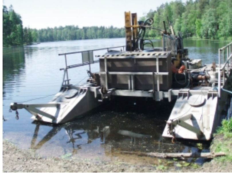
Järven pohjasedimentin näytteenotossa käytetty työlautta varustuksena A-sondi kevytkairakoneella ja näytteenottoon ST-II näytteenotin (Geotek Oy).
