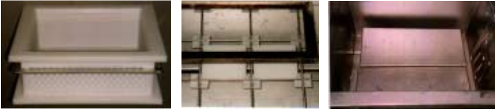
Kuva 31. Ultraäänipesurit ovat meijeriteollisuudessa etenkin juuston valmistukseen liittyviä laitteistoja: A) juustomuotti, B) testipaloja juustomuottimateriaalista (Laude BV, Alankomaat) ultraäänipesutelineessä ja C) ultraäänipesuri kahdella 1,2 kW:n ultraäänielementillä (TetraPak Tebel Oy, Suomi).
