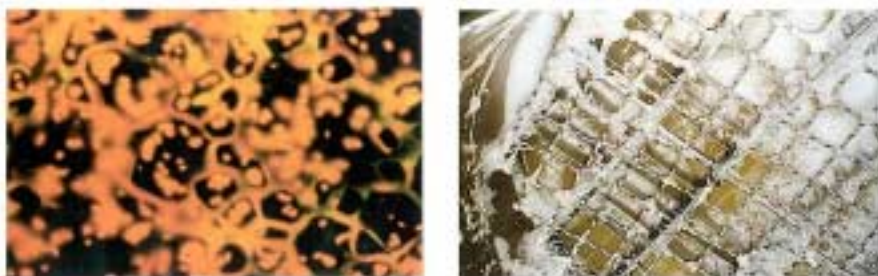
Kuva 2. Mikrobit tuottavat limaa laitepinnalla, mikä aiheuttaa tuotannon saastumista ja prosessissa ajettavuusongelmia. Vasemmalla on esimerkki Bacillus spp. -biofilimuodostuksesta ruostumattomalla teräspinnalla ja oikealla esimerkki Klebsiella spp. -limanmuodostuksesta.
