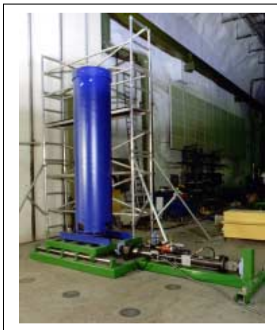
Kuva 26. Mallirakenne asennettuna tärypöydälle.
