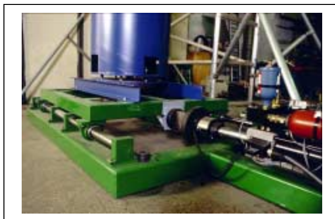
Kuva 27. Ulkoputken alapään tuenta lautasjousien avulla; Servo-ohjattu hydraulisylinteri, joka käyttää liukulaakerereita pitkin liikkuvaa tärypöytää.
