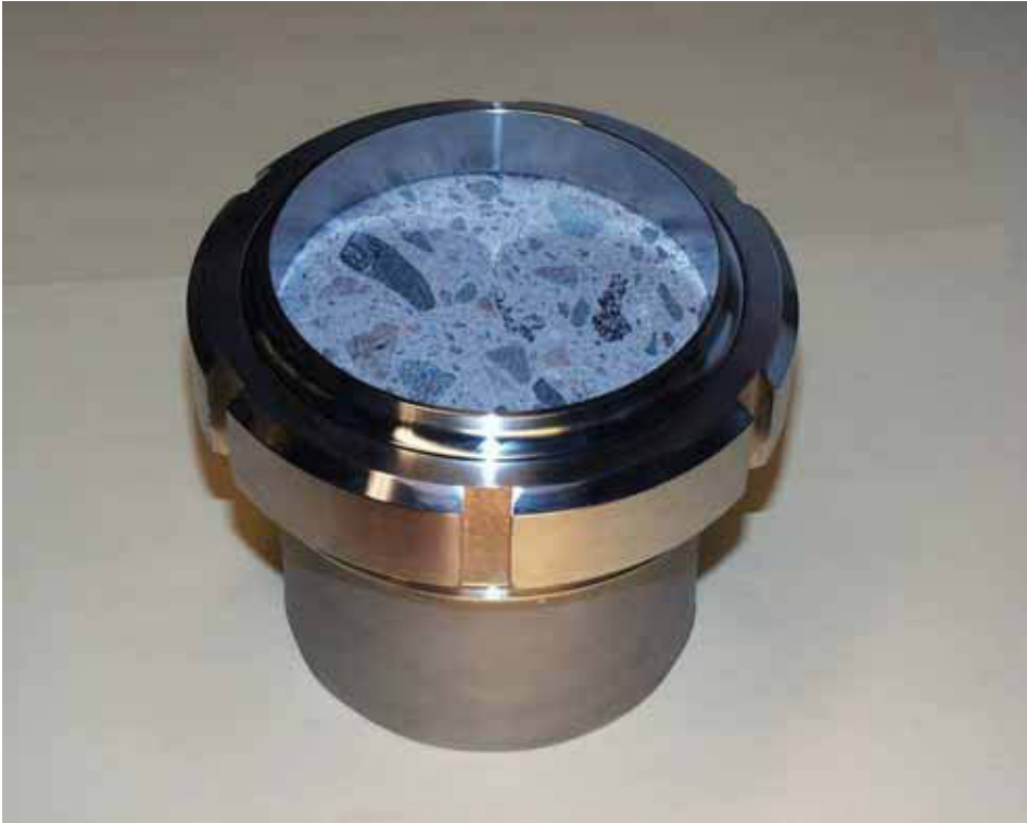
Kuva 45. VTT:llä valmistettu teräksinen näyteastia varustettuna betoninäytteellä.
