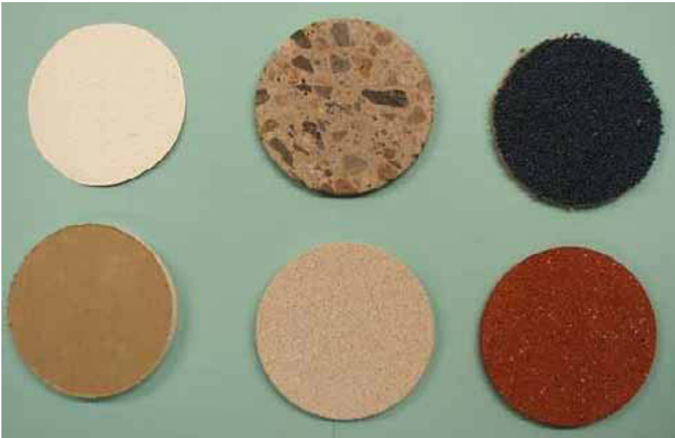
Kuva 47. Esikäsiteltyjä näyttemateriaaleja kuppikokeita varten. Kuvassa on akryylimaalattu tapetti, kiinteä betoni, kokolattiamatto, kipsilevy, kevytbetoni ja tiili.
