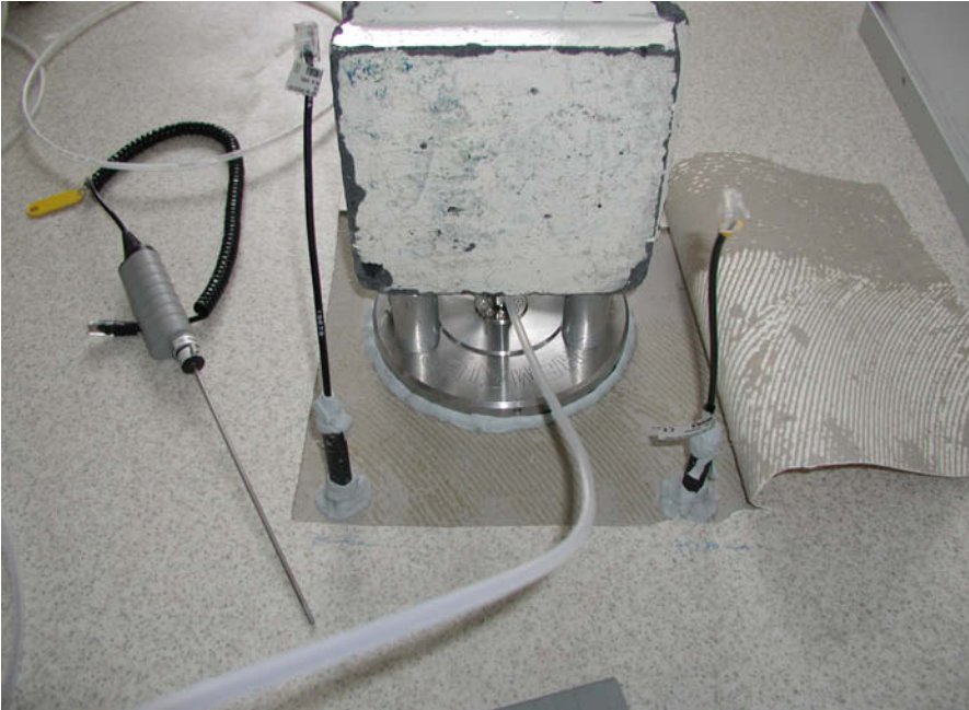
Kuva 4. Lattiarakenteen emissiomittaus PVC-pinnoitteen poiston yhteydessä ongelmakohteessa 3.
