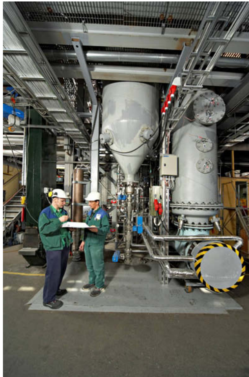
Kuva 24. VTT:n paineistettu koelaitte (UCG-PDU).
