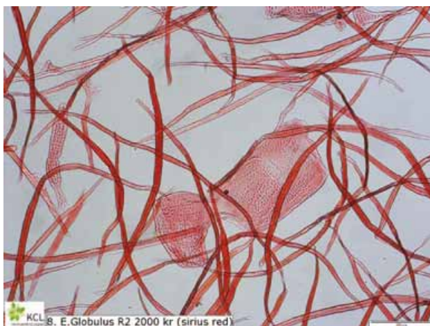
Figura 3. Fração rica em vasos de Eucalyptus globulus refinada / Figure 3. Refined Eucalyptus globulus vessel-rich fraction
