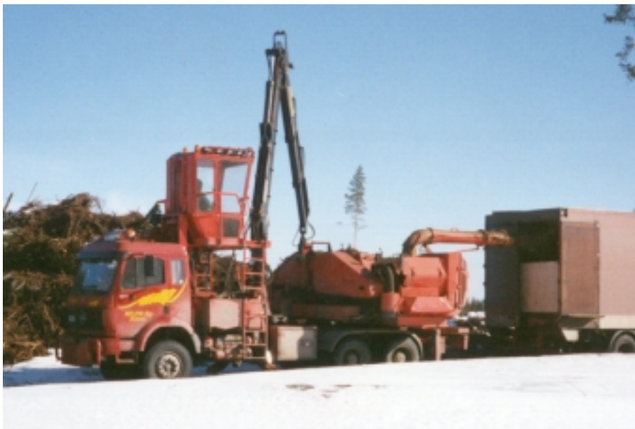
Kuva 1. Aikatutkimuksessa käytetty Mi-Pe Ky:n väliavarastohakkuri LT 57 R (Kuva Jarno Hämäläinen, Joensuun yliopisto).
