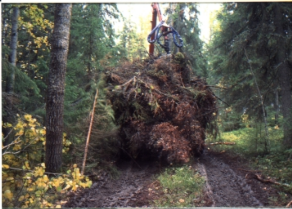
Kuva 5. Hakkuutähteen metsäkuljetusta maataloustraktori/perävaunu-yhdistelmällä.
