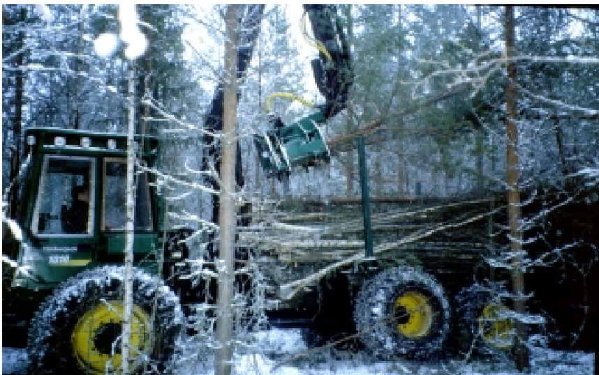
Kuva 1. Keräilykaatolaite toimii joukkokäsittelyperiaatteella, ja se soveltuu koko- tai osapuun korjuuseen. Kuorma tiivistetään puristuspankoilla.
