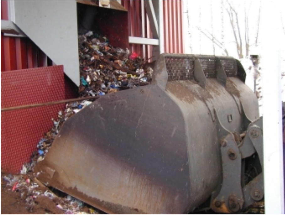
Kuva 3. RF-seulaylitettä Hämeenlinnan voimalaitoksella.
