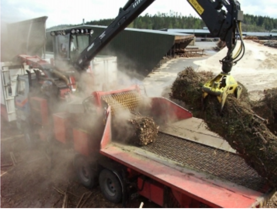
Kuva 3. Giant-hakkuri "risutukkien" haketuksessa.
