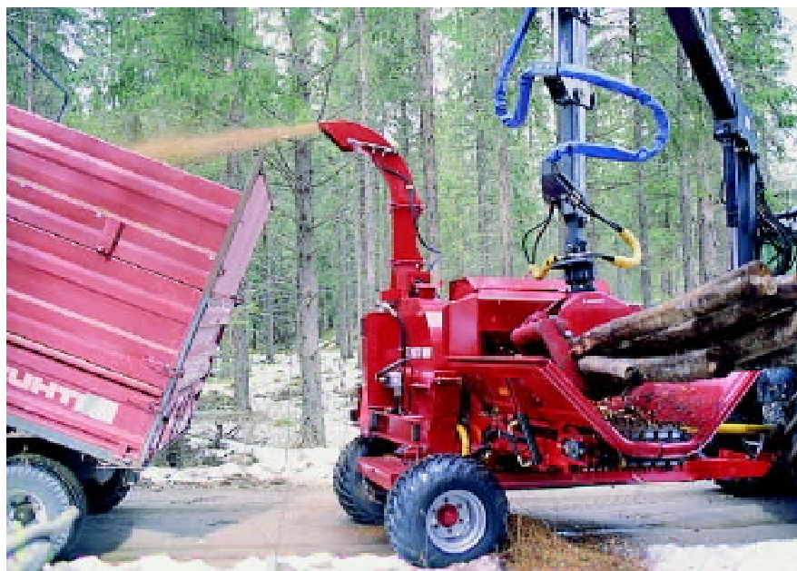
Kuva 1. FORESTERI C4560LF -rumpuhakkuri sekä FORESTERI 500 -kuormain haketuksessa.
