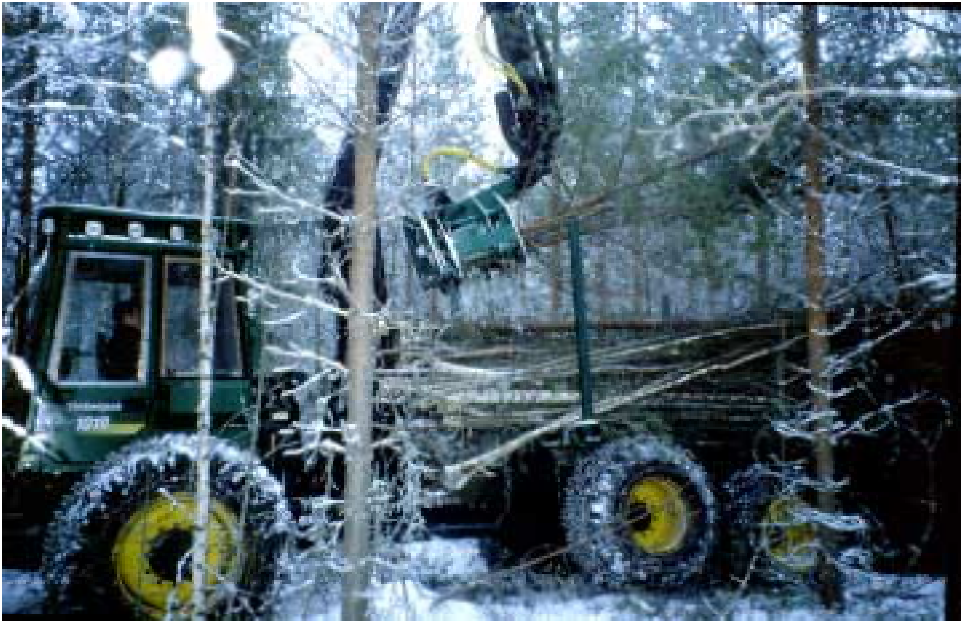
Kuva 1. Keräilykaatolaite ja metsäkuljetuskuorman tiivistyslaite.
