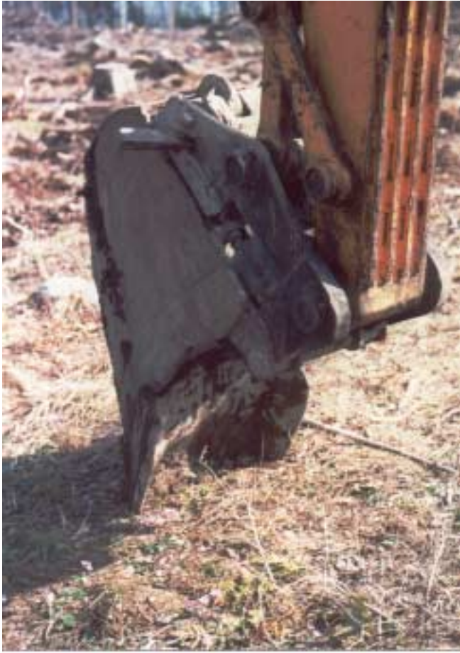
Kuva 4. Kaapeliojakauhan mätästysominaisuuksia on parannettu rakentamalla kauhan sivuille 10 cm:n levennykset.
