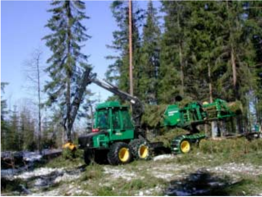
Kuva 1. Risutukkien paalain. Kuva: Timberjack.
