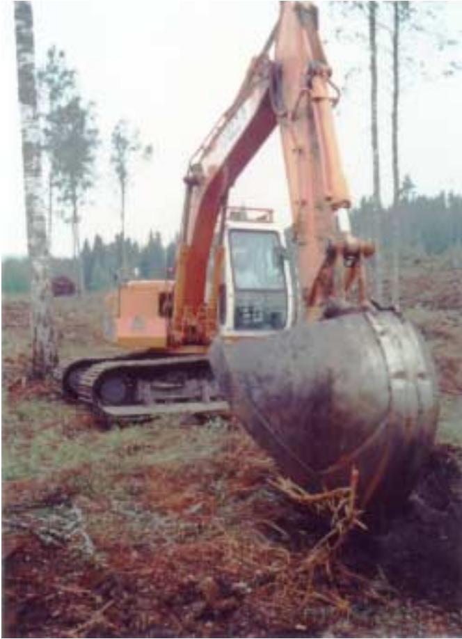
Kuva 1. Ojakauhalla varustettu Halla HE 130 LCE -kaivukone.
