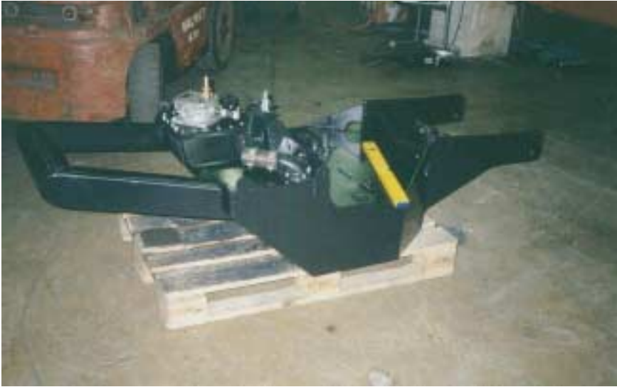
Kuva 1. Kuormaajan öljysäiliö odottamassa paikoilleen asennusta.
