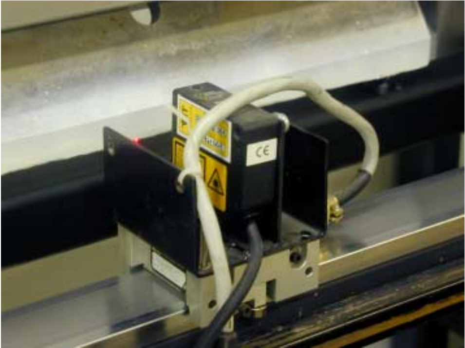
Kuva 2. Terän kulumisen mittaus lasermittalaitteella.
