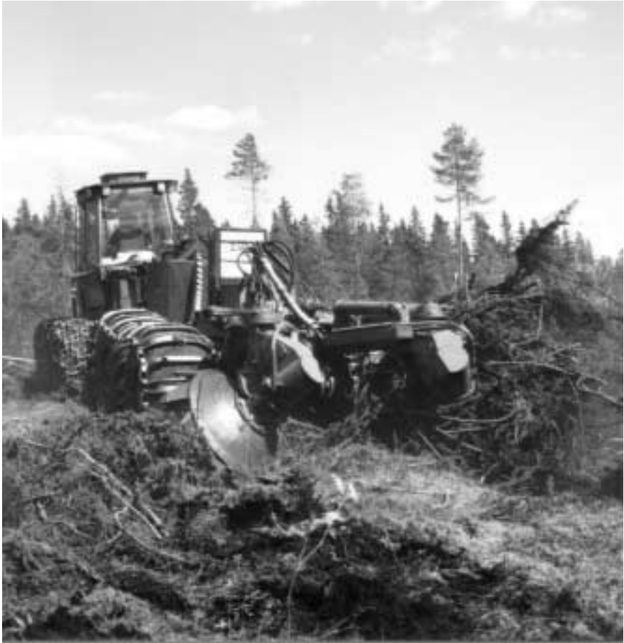
Kuva 3. Pieksämäen mlk:n koekentän äestykset tehtiin TTS Delta II:lla. Peruskoneena oli etutelillä varustettu Valmet 860 -kuormatraktori.
