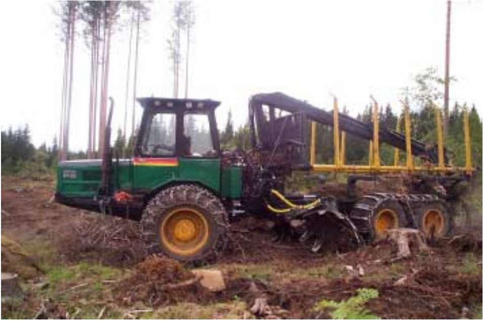
Kuva 2. Yhdistelmäkone hakkuutähteen korjuuseen ja maanmuokkaukseen.
