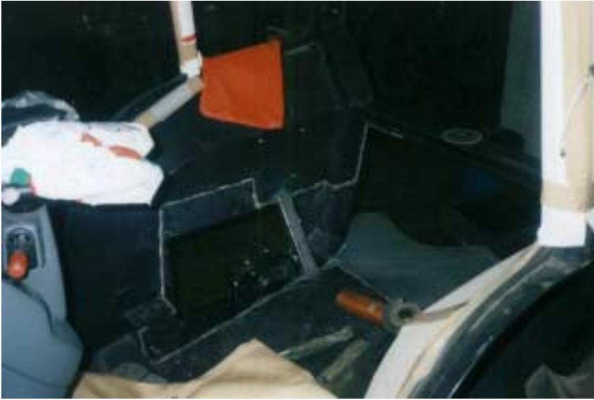
Kuva 2. Mekaaniset vivut ja vanha hallintapaneeli poistettu ohjaamosta.
