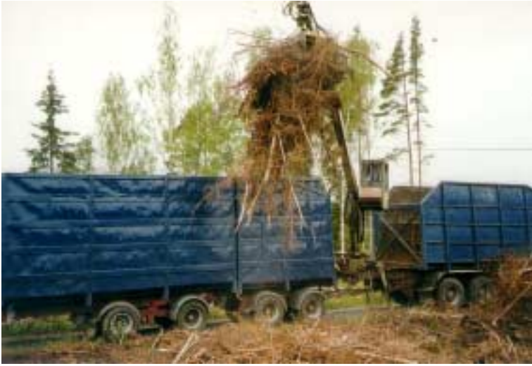
Kuva 2. Kuljetusliike Hakonen S. ja Pojat Ky:n (Pori) rakentama hakkuutähdeauto. Teleskooppirunkoinen perävaunu mahdollistaa lastauksen ja purkamisen perävaunua irrottamatta.
