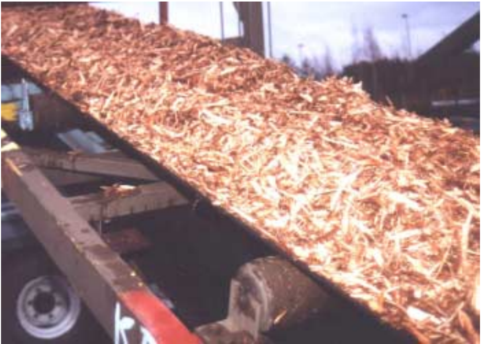
Kuva 3. Murskauslinjalla murskattua kuusen hakkuutähdemurskettä.
