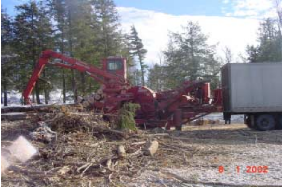
Kuva 4. Kokopuun haketusta suoraan rekan puoliperävaunuun Vermontissa (tammikuu 2002).
