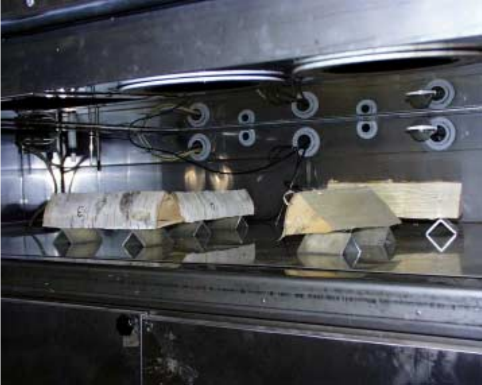
Kuva 1. Koivupilkkeitä kuivumassa olosuhdesimulaattorissa.
