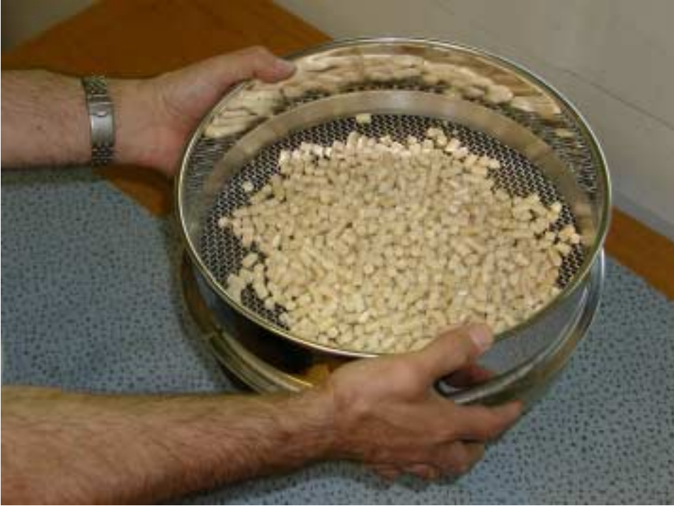
Kuva 1. Pellettien sisältämä hienoaines voi haitata varastosiilojen sekä kuljetin- ja lämmityslaitteiden toimintaa. Pellettien hienoaines määritetään 3,15 mm:n verkkoseulalla (DIN ISO 3310-1) käsin seuloen.
