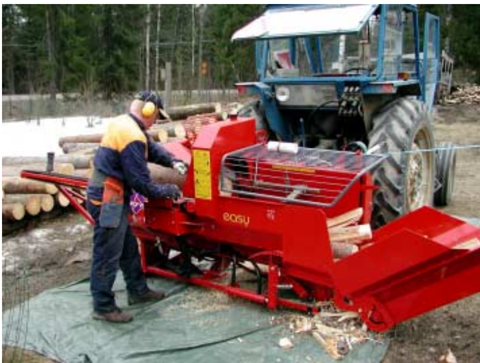
Kuva 1. Vihdissä tutkittiin yhteensä yhdeksää polttopuun pilkkomislaitetta, joista seitsemän oli katkaisu-halkaisulaitteita ja kaksi halkaisulaitteita. Kuvassa Maa-selän Kone Oy:n valmistama katkaisu-halkaisulaite. Kuva: Arto Mutikainen.
