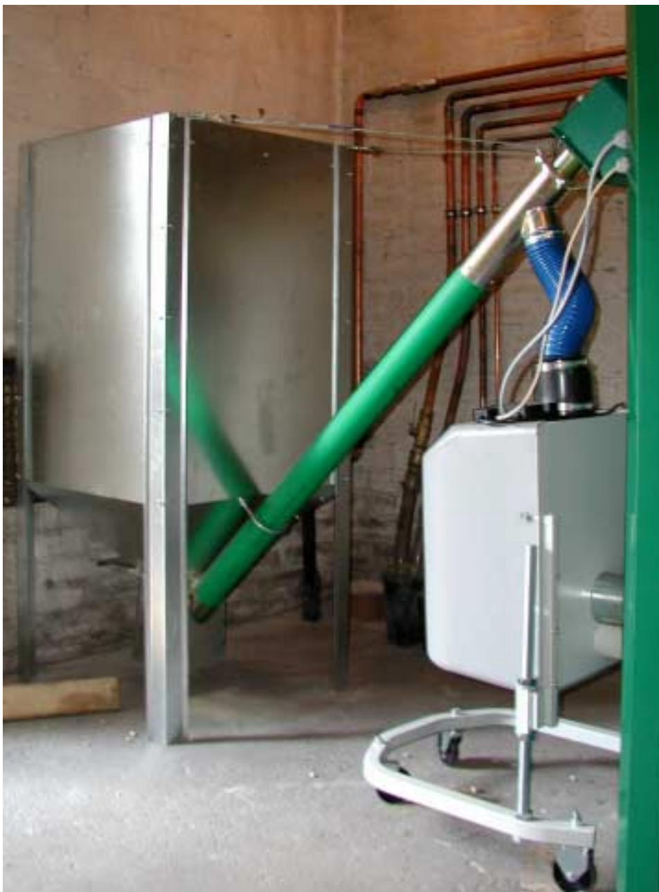
Kuva 4. Pellettien syöttökokeilla selvitetään kuljettimen rakenteen ja asennustavan vaikutusta pellettien murskautumiseen.
