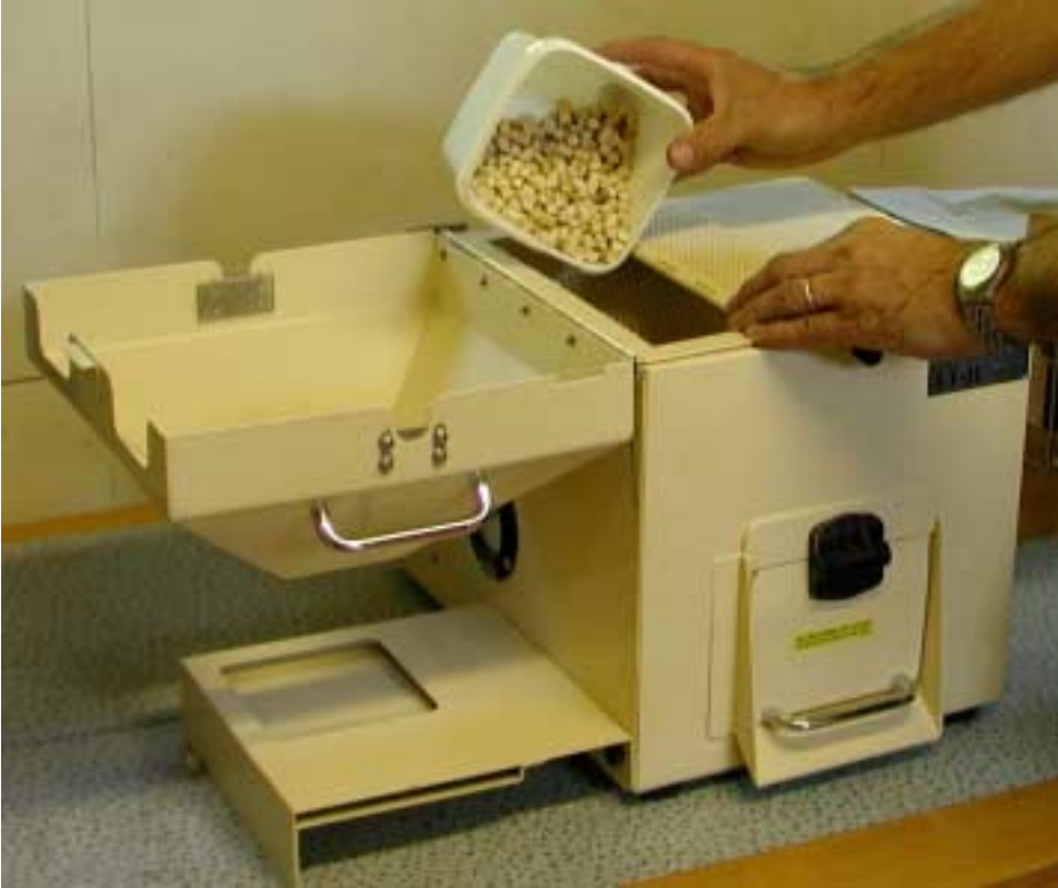
Kuva 2. Käsittelykestävyys kuvaa pellettien mekaanista lujuutta kuluttavia voimia vastaan. Käsittelykestävyys määritetään laitteella (Lignotester), jossa pellettejä rasitetaan ilmasuihkuilla.
