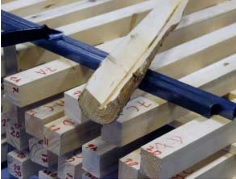
Kuva 3. Sahattuja näyterimoja ja männyn oksan jäännöspala.
