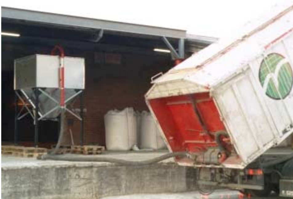
Kuva 3. Käyttökokeilla selvitetään puhallusautokaluston rakenteen ja purkutapojen vaikutusta pellettien jauhautumiseen.
