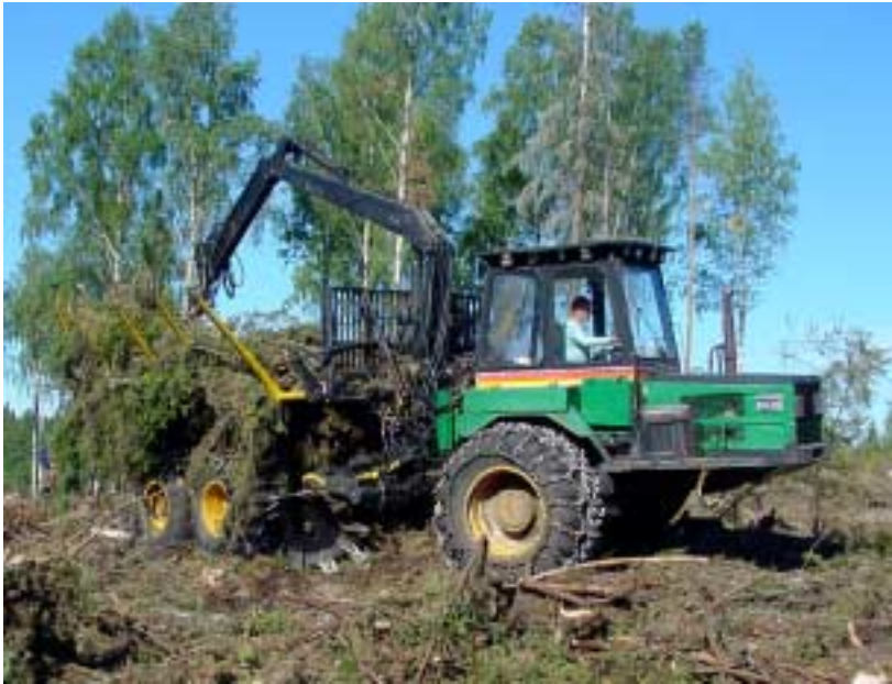
Kuva 1. Maanmuokkaus- ja hakkuutähteiden metsäkuljetuskone töissä Liperin Haapovaarassa (valokuva Y. Nuutinen, 2001).
