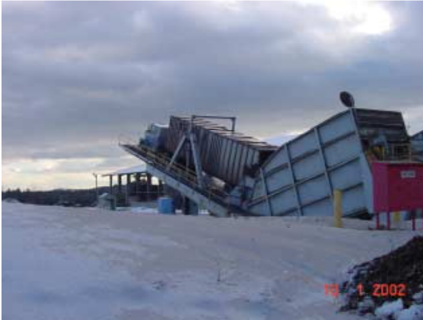
Kuva 5. Hakkeen purkua rekasta laitoksella Vermontissa (tammikuu 2002).
