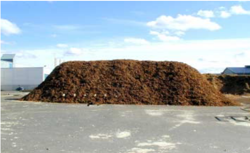
Kuva 1. Ilmastoitu koekuorivarasto. Ilmastointi toteutettiin sijoittamalla varaston toiseen pätyyn salaojaputkia metrin korkeudelle maan pinnasta yhden metrin välein.
