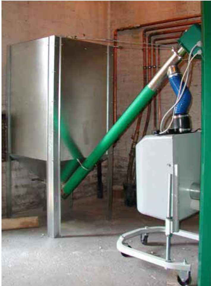
Kuva 3. Pellettien syöttökokeilla on selvitetty kuljettimen rakenteen ja asennustavan vaikutusta pellettien murskautumiseen. Kuva: Seppo Tuomi.
