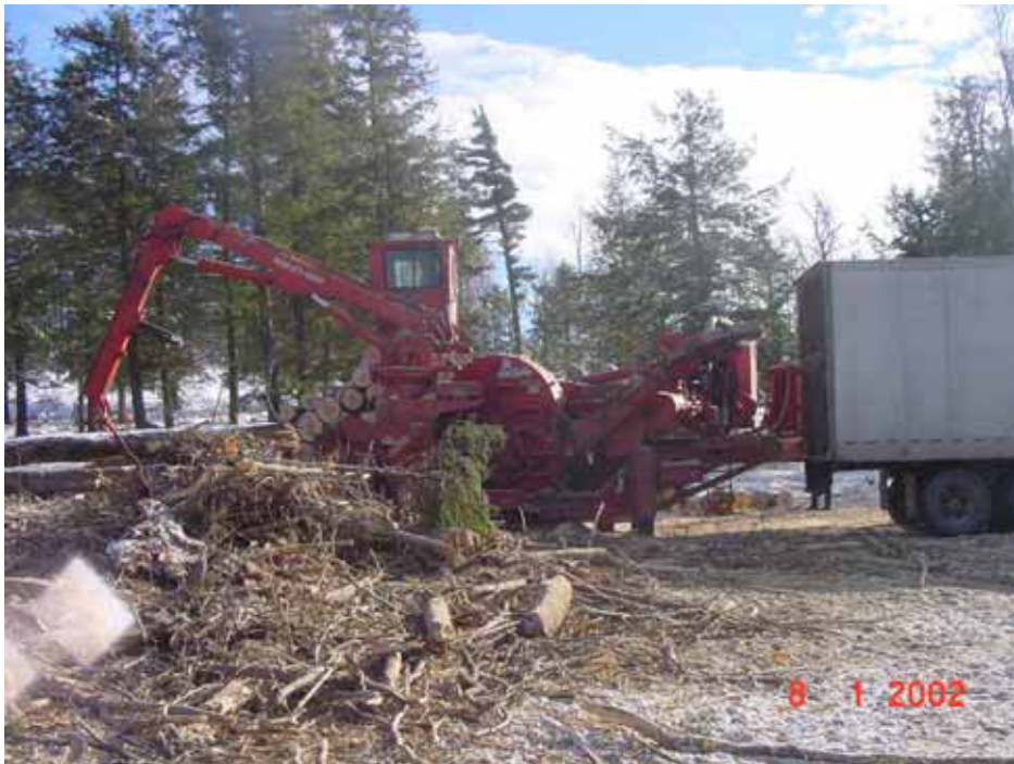
Kuva 4. Kokopuun haketusta suoraan rekan puoliperävaunuun Vermontissa.
