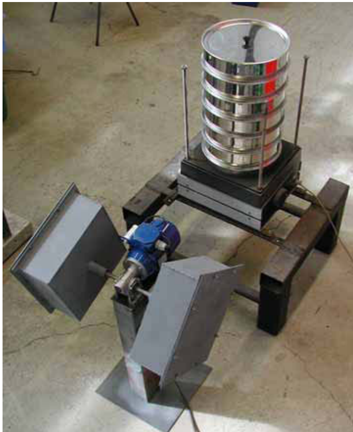
Kuva 1. Pellettien käsittelykestävyyden mittaamenetelmistä tehtiin kansainvälinen vertailututkimus viiden maan erilaatuisilla pelleteillä. Kuvassa laatikkorumpuun perustuvan menetelmän testaus. Kuva: Arto Mutikainen.
