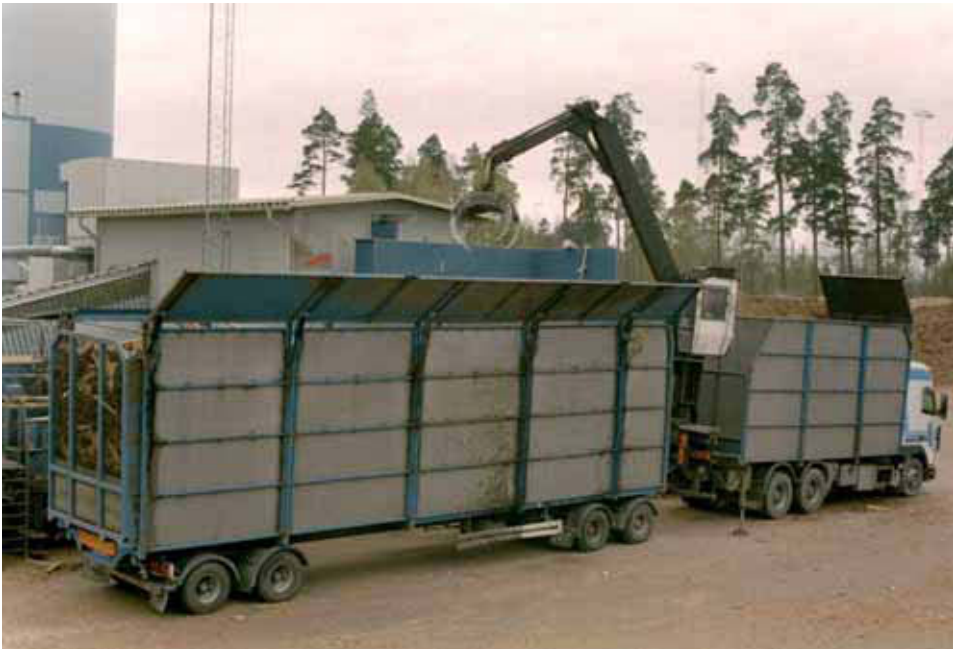
Kuva 1. Risuauto Norrköpingissä. Huomaa perävaunun kattoluukut ja vetoauton lavan etupään levy.
