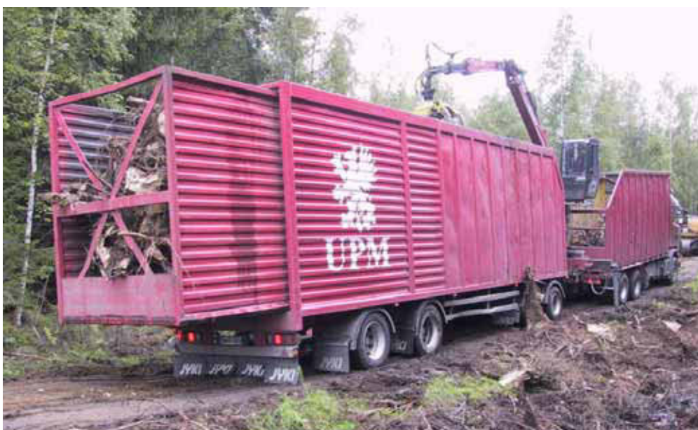
Kuva 2. Metsäpolttoaineiden kuljetukseen soveltuva erikoisauto.
