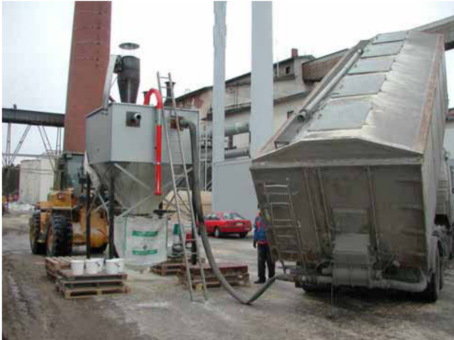
Kuva 2. Jakelukokeilla on selvitetty puhallusautokaluston rakenteen, purkutavan ja pellettisiilon rakenteen vaikutusta pellettien murskautumiseen erilaatuisilla pelleteillä. Kuva: Seppo Tuomi.
