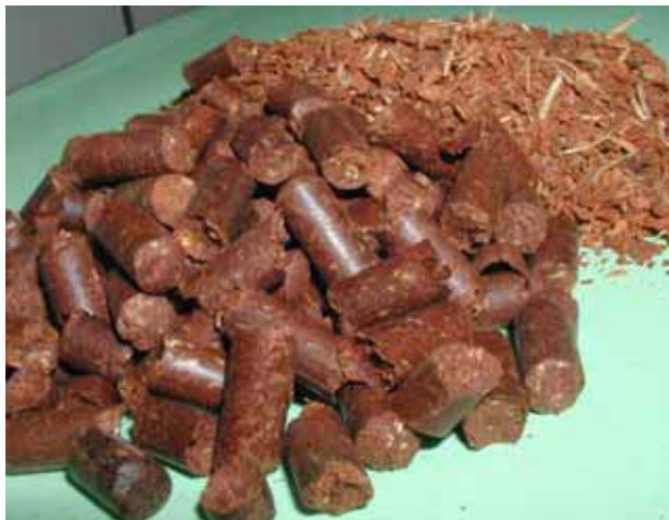
Kuva 4. Korkealaatuisia Amandus-Kahl-puristimella männynkuoresta valmistettuja pellettejä (halkaisija 8 mm).
