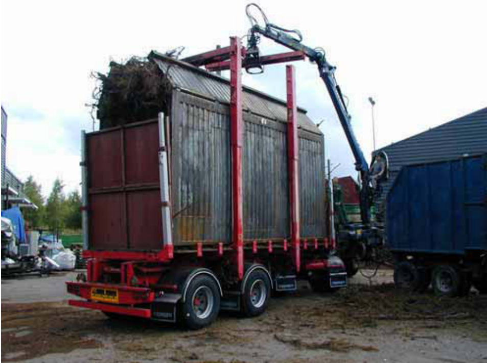
Kuva 4. Tiivistävät kansiluukut VTT:n koekärryssä.
