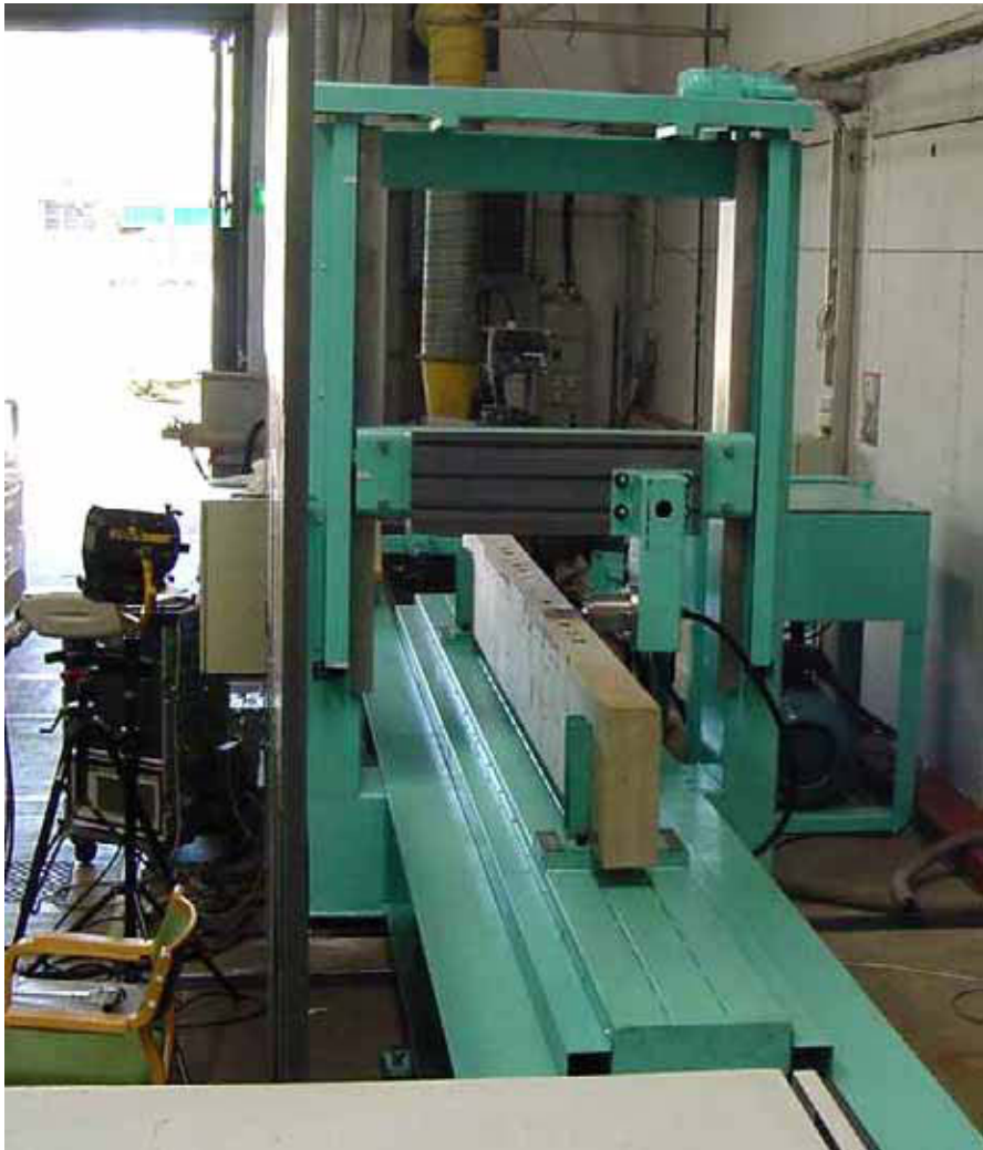
Kuva 2. Koelaitte, jonka pöydällä liimapalkki ja raamipalkissa teräpidin ja terä.
