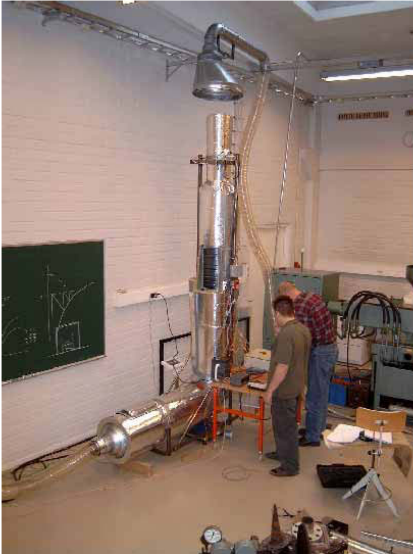
Kuva 1. Kuivausmittalaitteen ilmavirta ja sen lämpötila ovat portaattomasti säädettävissä. Vaaka, jonka päälle laitteisto on asennettu, näkyy kuvassa taustalla. Kosteaa ilmaa poistetaan laboratoriotilasta ylhäällä näkyvän huuvan ja taipuisan poistokanavan kautta. Laboratorioinsinööri Pekka Anttonen (taustalla) ja insinööriopiskelija Peter Pyykkönen asentamassa tiedonkeruulaitteita toimintakuntoon.
