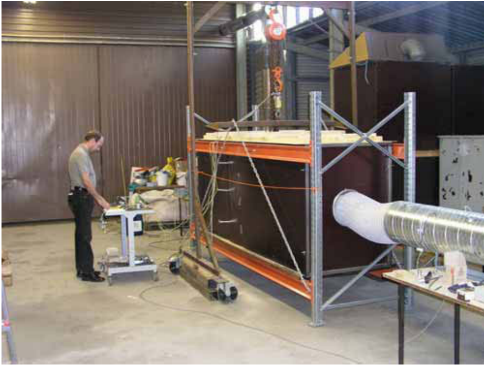
Kuva 3. Työtehoseuran lämpökoesemalle rakennetulla koekuivurilla tutkitaan pilkkeen palakoon, kuivausilman määrän ja jakotavan sekä pilkkeen pinoamista- van vaikutusta pilkkeen kylmä- ja lämminilmakuivauksessa.
