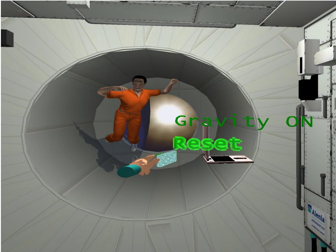
Kuva 4. Astronauttien kokoonpanon koulutussimulaatio nollapainovoimassa. Kuva on VTT Tietotekniikassa kehitetystä astronauttien koulutussimulaattorin prototyypistä [3]. Valikoiden ja esineiden käsittely suoritetaan datahanskoja käyttämällä.
