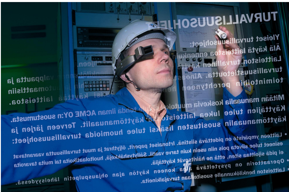
Kuva 5. Huoltomies tarkastelee virtuaaliympäristöä silmikkönäytön kautta ja ohjaa puheella käyttöliittymää. Hän pystyy samalla operoimaan käsillään ja tarkastelemaan todellisen maailman kohteita.
