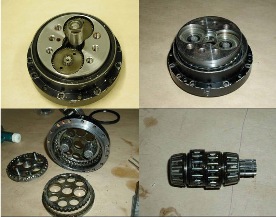
Kuva 4. Robotin nivelessä J3 käytetty planeettavaihte. Ylhäällä vasemmalla planeettavaihte ja ensiöpuolen sisäpuolinen keskuspyörä ( n_1 ), oikealla sisäpuolinen keskuspyörä ja ensimmäisen portaan planeettarattaat on purettu. Alhaalla vasemmalla vaihteen toisen portaan planeettapyörät ja ulkopuolinen, sisähammastettu keskuspyörä. Oikealla planeettapyöriä kampeava akseli.
