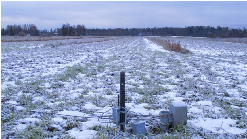
Kuva 22. Langaton mittaussolmu lisäakkukoteloineen on vasemmalla. Langallisen mittalaitteen solmu on oikealla.
