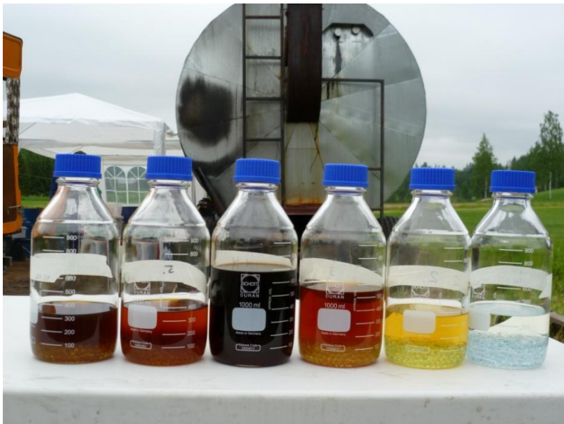
Kuva 3.3. Hiilretortti sekä kaasunäytteenotossa saatuja isopropanoliliuosnäytteitä. Näytteiden ajallinen järjestys on oikealta vasemmalle.
