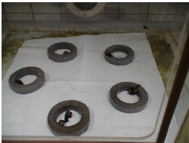
Kuva 5.1. Tisleiden karkotusvaikutusta lehtokotiloihin tutkittiin kammiossa mittamalla aika, jonka kotilot pysyivät eri aineilla siveltyjen renkaiden sisällä.
