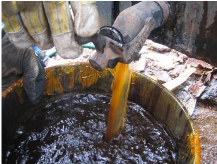
Kuva 3.1. Nestetuotteen (tisle + terva) ulosotto retortista koivupuun hidaspyrolyysikoeajossa.
