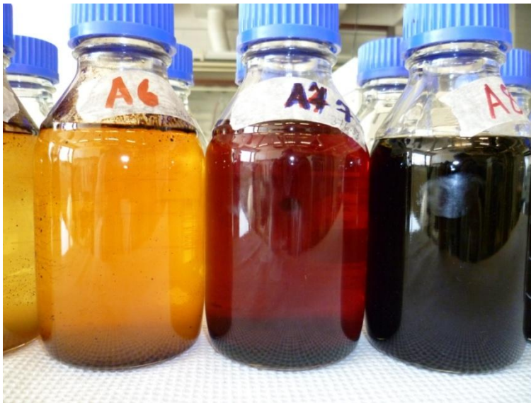
Kuva 3.4. Koivupuun hidaspyrolyysikoeajon aikana kerättyjä nestenäytteitä. Kuvassa näkyy tervaosan muodostuminen näytteisiin.
