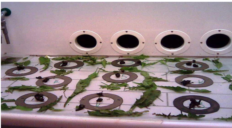
Kuva 6.1. Tisleen karkotetehoa tutkittiin mittaamalla aika, jonka kotilot pysyivät 3,5-prosenttisella tisleellä käsitellyissä renkaissa.
