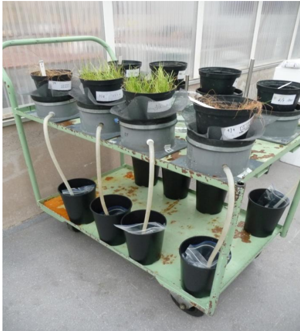
Kuva 6.5. Tisleen kulkeutuminen suodosveteen. Suodosalustoille asetettuihin astioihin lisättiin vettä, jolloin suodosvesi valui letkua pitkin alla olevaan astiaan.
