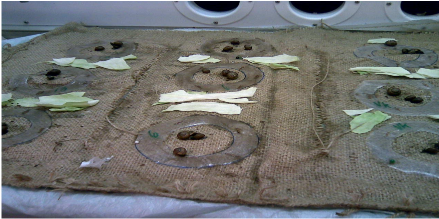
Kuva 6.2. Vaseliinin ja tutkittavan tisleen seoksella maalattujen muovirenkaiden sisään asetettiin kolme lehtokotiloa.
