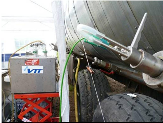
Kuva 3.2. Kaasunäytteiden otto retortin kylkeen sijoitetun kaasusondin avulla koivupuun hidaspyrolyysikoeajossa.
