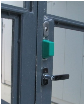
Kuva 16. OVI 4 -kokeen geometriassa käytetty lukkomekanismi (ovi aukeaa vetämällä). Kuvan painonappi ei ollut toiminnassa kokeiden aikana, vaan oven aukeamisen edellytyksenä oli vihreän kuvun rikkominen. Työntämällä aukaistavassa ovesa ei ollut painonappia.
