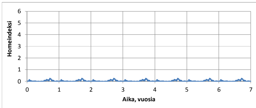
Kuva 71. Laskettu homeindeksi seitsemän vuoden aikana puupinnoilla, jotka ovat kuvan 69 mukaisessa lämpötilassa ja kosteudessa.
