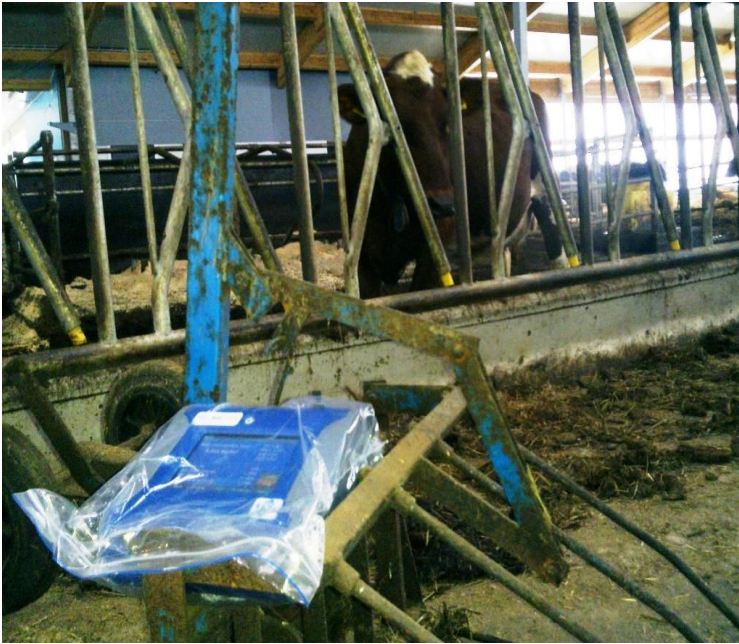
Kuva 50. Mittausanturit lämpötilalle, kosteudelle ja hiilidioksidille.
