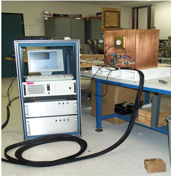
Kuva 15. Kevyt NMR-laitteisto (pöydällä magneetti, RF-kela ja vahvistin sekä "teollisuuskoteloissa" pc ja virransyöttöjärjestelyt). Kaapeli mittausyksikköön on 6 m (Magnuson 2005).
