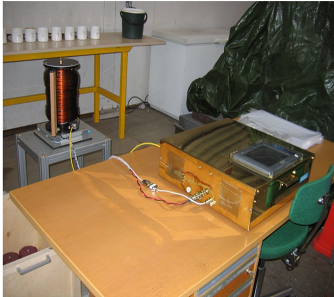
Kuva 16. Vaisalan MR-kosteusmittauslaite (cpu edessä pöydällä ja sähkömagneettikela vasemmalla sekä seinän vieressä pöydällä näyteastioita, jotka mitataan kelan sisällä).
