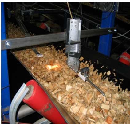
Kuva 12. Kaksi impedanssianturia mittaamassa selluhakkeen kosteuspitoisuutta (vasemmalla) ja menetelmän tarkkuus verrattuna referenssimittaukseen.
