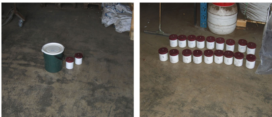
Kuva 29. Yksittäisnäytteen jakamisen välineet (vasemmalla) ja oikealla kuva yhden kuorman yksittäisnäytteistä MR-laitteen mittaustasioissa.
