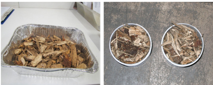
Kuva 18. Standardin mukainen näytemassa (~300 g) ja kaksi MR-näyteastiaa (~ 2 x 150 g).
