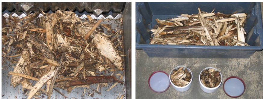
Kuva 4. Kantonäytteen murskausta ja jakamista kosteusmäärittämiseen MR-kosteusmittauslaitteella.
