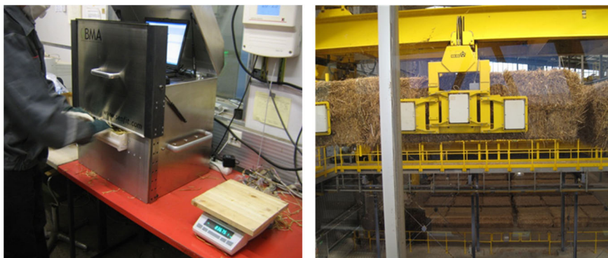
Kuva 9. Ruokohelpin (vasemmalla) ja olkipaalin kosteusmittausta mikroaaltoperiaatteella.
