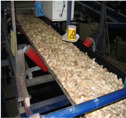
Kuva 10. Radiometristä tiheyden mittausta ( ^{241}\text{Am} ja ^{137}\text{Cs} lähteet) (vasemmalla) ja radiometriseen perustuvan kosteusmittauksen tarkkuus tasalaatuisella hakkeella (oikealla).
