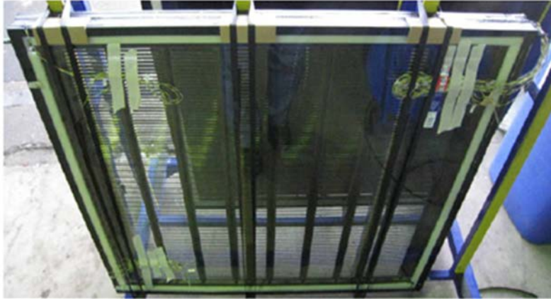
Kuva 25. Sähköntuotanto ikkunaan integroidun, osittain läpinäkyvän PV-kennoston avulla.
