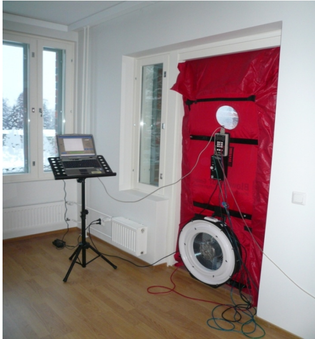
Kuva 6. Tiiviysmittauslaitteisto (kuva ei ole kohteesta).
