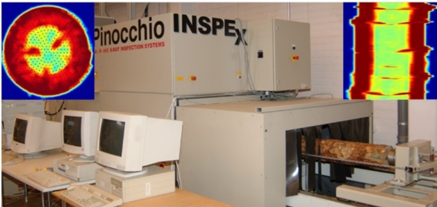
Kuva 26. VTT:n röntgenjärjestelmä tukkien ja sahatavaran sisäisten ominaisuuksien tarkaksi määrittämiseksi.
