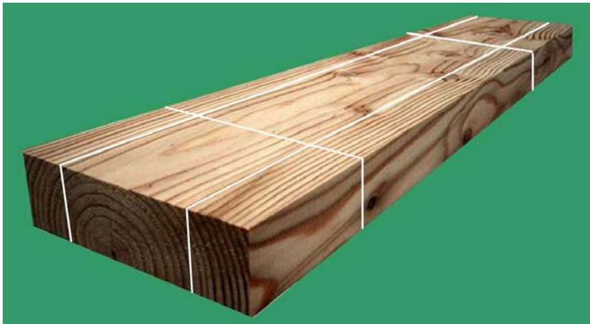
Kuva 11. Komponentin keski-, reuna- ja päätyalueet, joilla voi olla erilaiset laatuvaatimukset.
