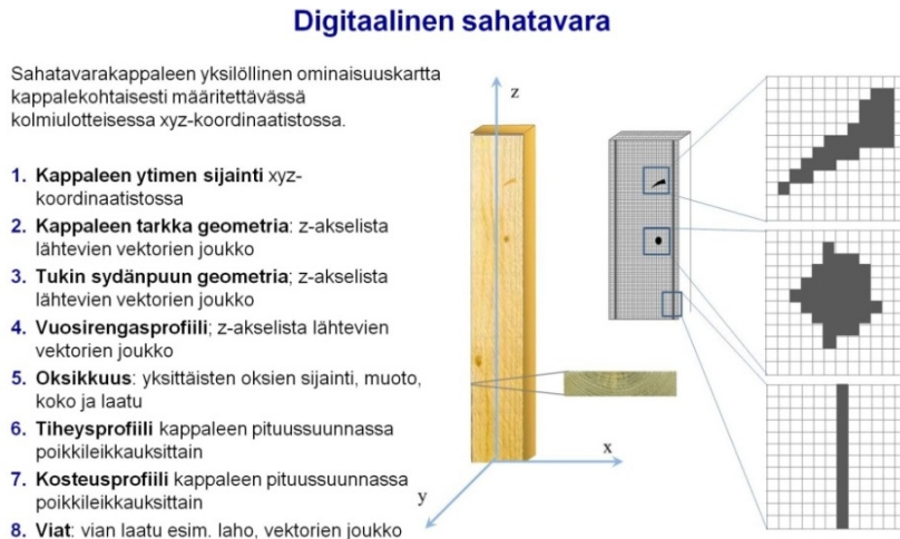
Kuva 8. Sahatavarakappaleen digitaalinen kuvaus.
