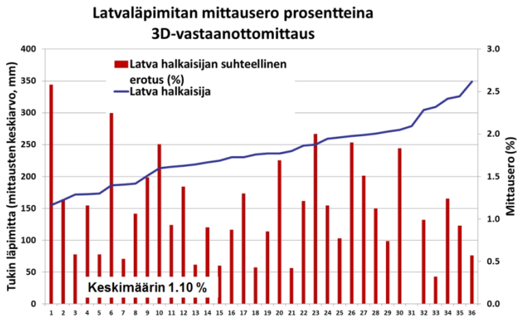
Kuva A6. 3D-vastaanottomittarin määrittämän latvaläpimitan kolmen mittauksen toistotarkkuus tukeittain männyllä ja kuusella. Tukat lajiteltu latvaläpimitan mukaan suurusjärjestykseen.
