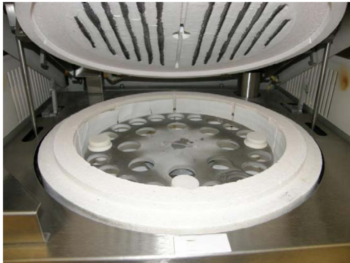
Kuva 3.5. Termogravimetria (TGA) -laite, jossa on 20 kpl näyteupokkaita, joihin mahtuu 5 g näytettä.
