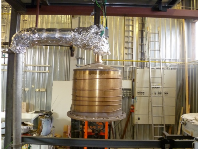
Kuva 3.3. Retorttikaasujen johtaminen jäähdyttimelle.
