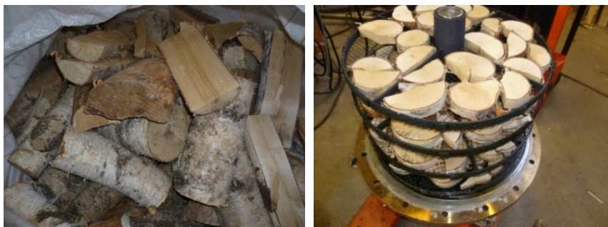
Kuva 4.1. Koivurankaa ja sahattuja koivukiekköjä (leveys 50–150 mm ja paksuus 25 mm) asetettuna pyrolyysilaitteiston näyteritilöille koeajoa varten.
