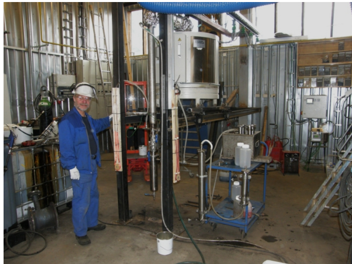
Kuva 3.4. Retorttikaasun jäähdytys, tisleen talteenotto ja kaasujen puhdistus.
