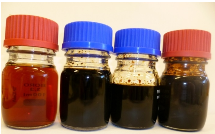
Kuva 4.6. Ensimmäisen vaiheen tisle (kokoomatisle A) ja 300, 375 ja 475 °C:n hiiltokoeajojen tisleet B (vasemmalta oikealle).
