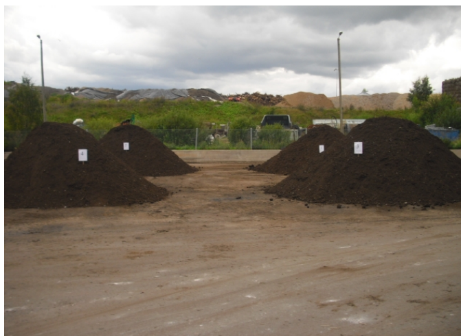
Kuva 7.1. Koekompostit Envor Biotech Oy:n alueella. Kasoissa oli 10 m 3 kompostoituvaa turvetta ja orgaanista jätettä.
