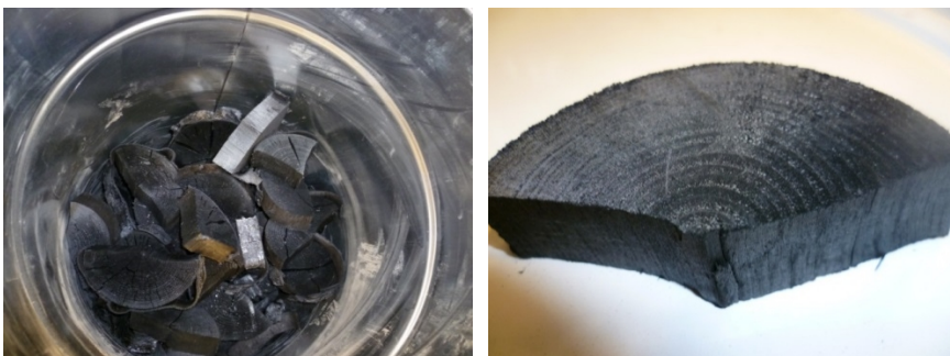
Kuva 4.4. Keskilämpötila-ajossa (375 °C) (vasemmalla) ja korkealämpötila-ajossa (475 °C) (oikealla) tuotettuja hiiliä.
