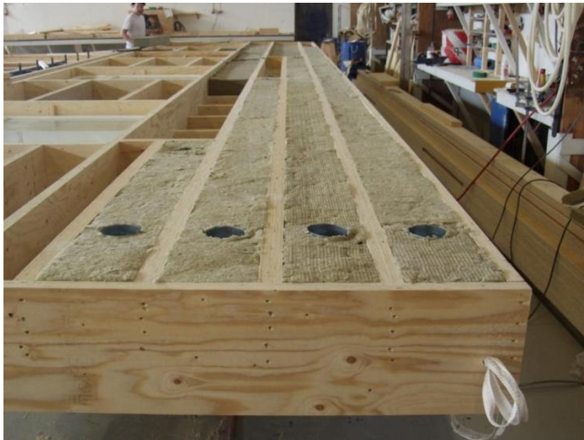
Kuva 11. Ilmanvaihtokanavien läpiviennit TES-elementissä.
