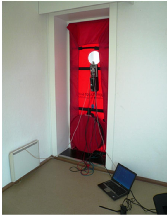
Kuva 28. Ilmatiiveyden mittaus Blower Door -tiivysmittauslaitteistolla.
