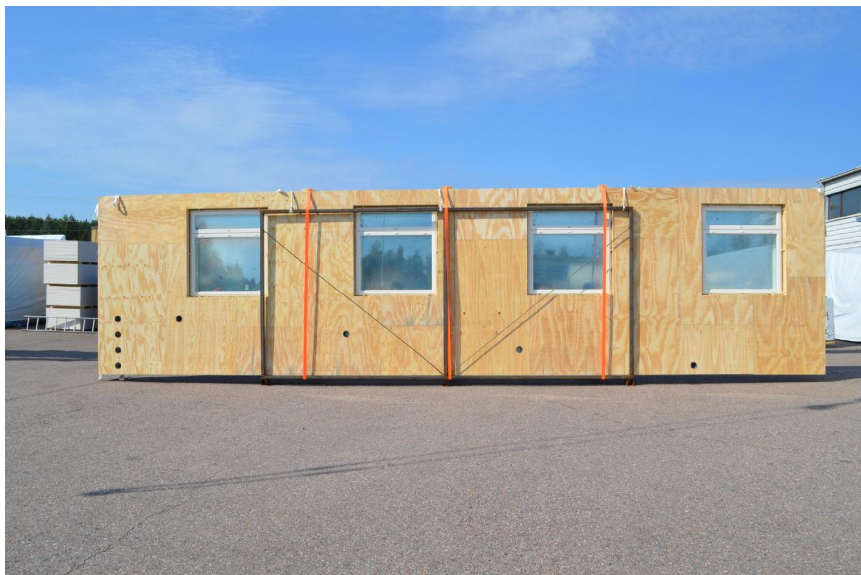
Kuva 14. Valmis TES-elementti tehtaan pihalla.
